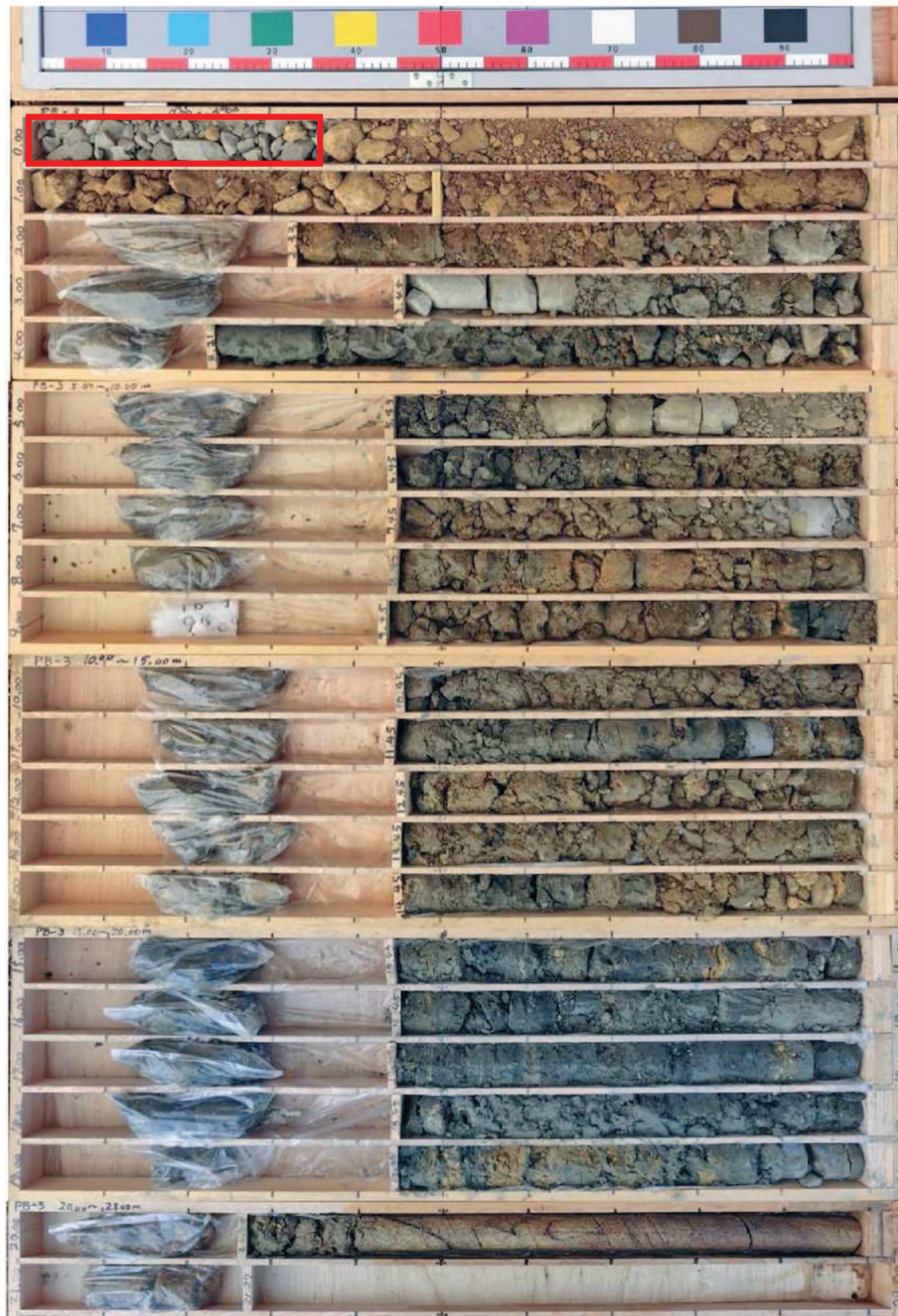
図 1-4(2) ボーリングコア写真 (PB-3) (盛土: 深度 0~19.95m)
