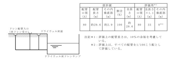
図7-4 ドレン配管移送時間(ドレン配管入口~ドライウェル床ドレンサンプ)
