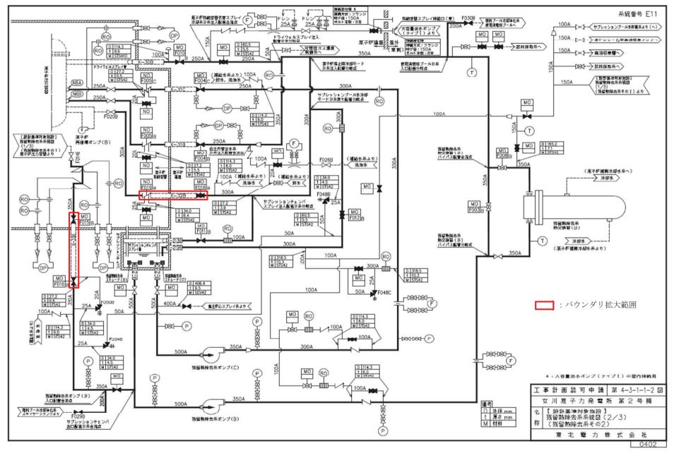
図2 残留熱除去系(B)系統図
