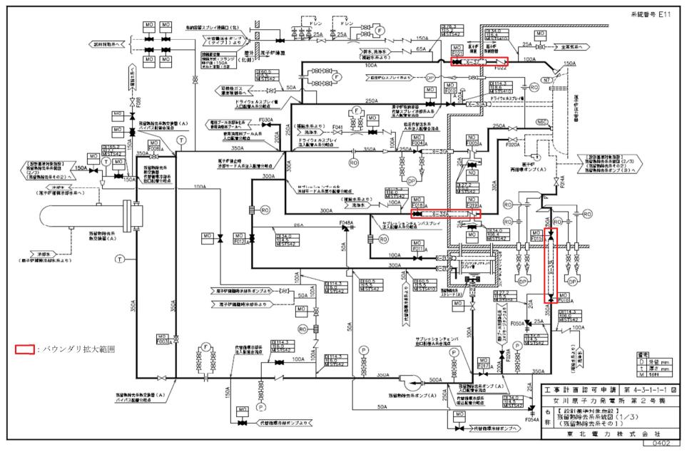
図1 残留熱除去系(A)系統図
