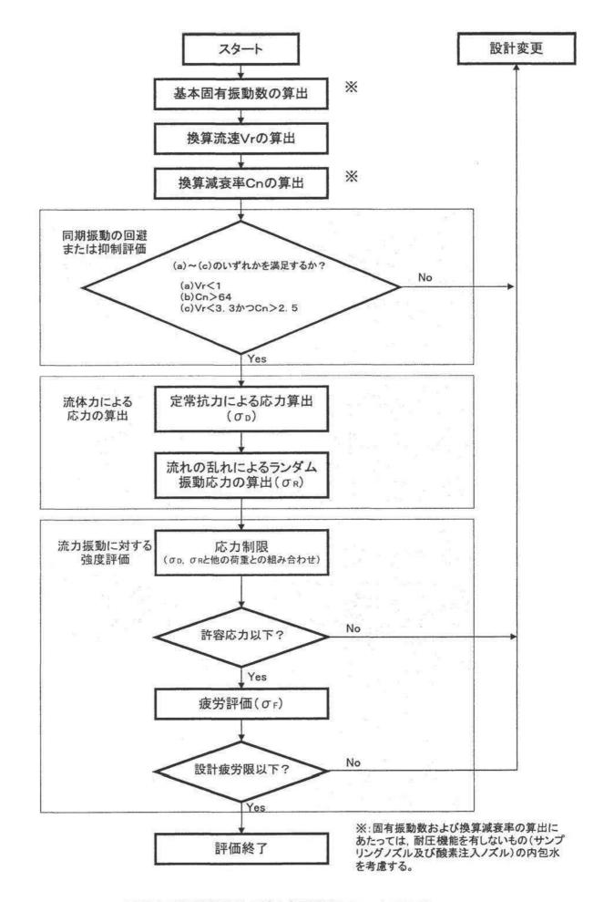
配管内円柱状構造物の流力振動評価フロー(JSME)
