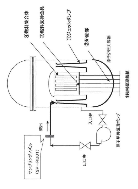
原子炉再循環系出口配管サンプリングノズル想定流入, 滞留経路
