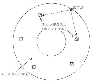
図7-3 落下点からドレン配管入口(床ドレン受口)までの到達時間における概略図
