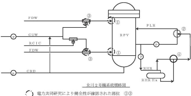
電力英向研究により健主性が確認された部位 ①③ 日本機械学会基準に準拠した評価により健全性が確認された部位 ② 検査対象部位 ④
