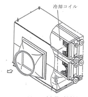
図4-1 冷却器の概略図
