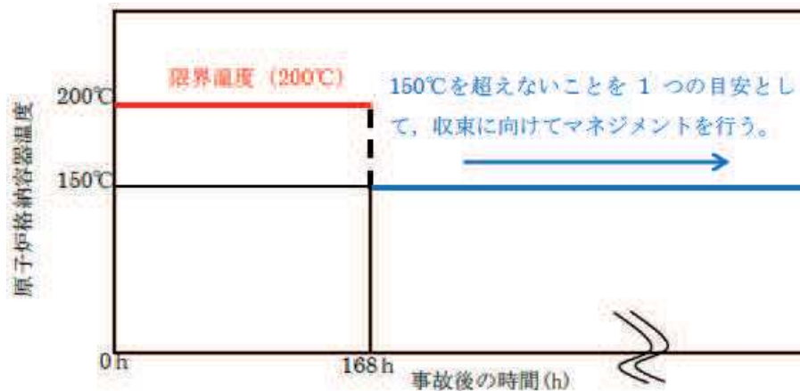
図5 原子炉格納容器温度の168時間以降の考え方
