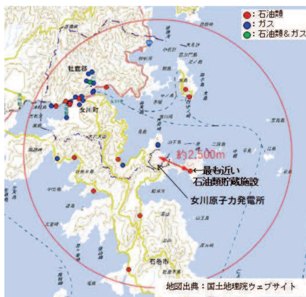
図 3.2-1 発電所から 10km 圏内に位置する危険物貯蔵施設
