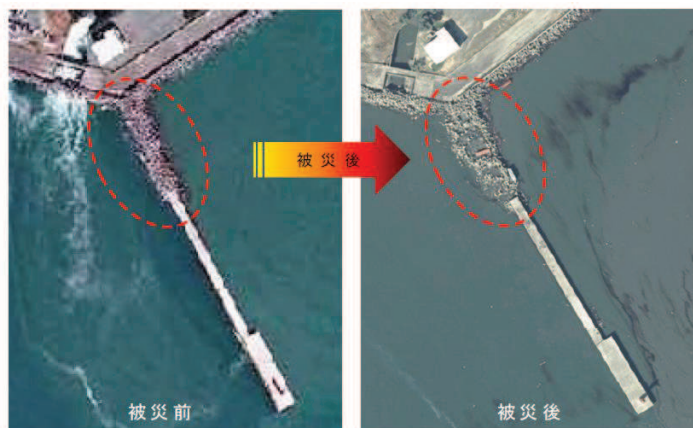
外港地区 北防波堤 (平成23年2月16日、3月12日撮影⑦) 消波ブロック飛散(100m)
