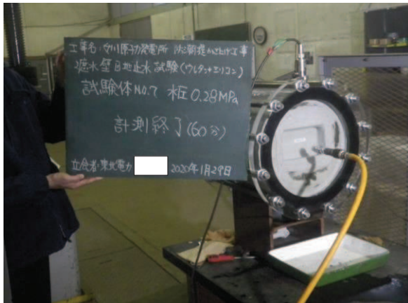
図 6.1.5-17(10) ウレタンシリコン目地耐圧試験結果（試験体 No.7）
