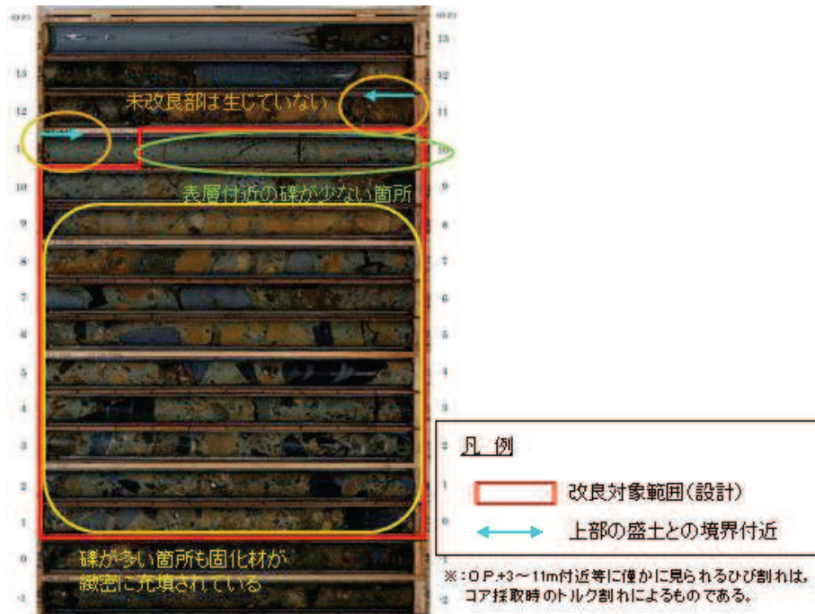
図 6.4-12 ボーリングコア写真 (③孔)
