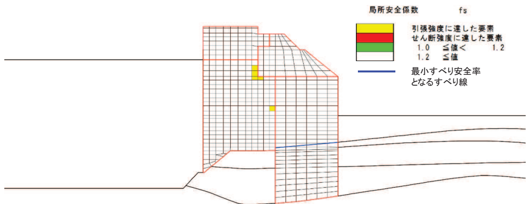
図 4.1-4(3) 置換コンクリートの局所安全係数分布 (断面③) 解析ケース③：地盤物性のばらつきを考慮した解析ケース (平均値 - 1σ)
