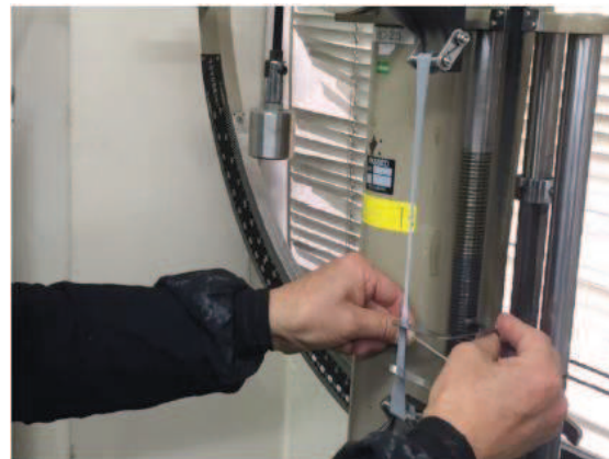
図 6.1.5-25(4) シリコーン材の耐候性試験 (引張試験)
