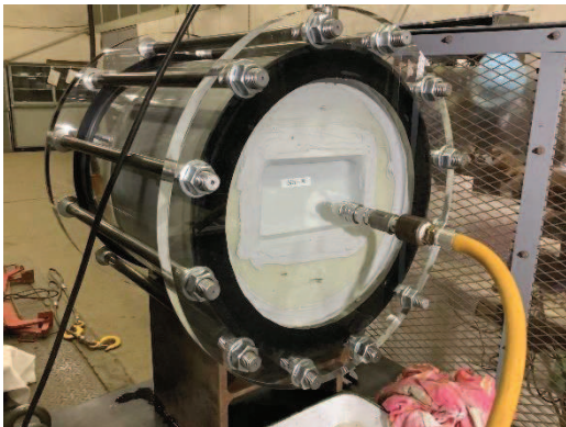
図 6.1.5-17(9) ウレタンシリコーン目地耐圧試験状況 (試験体 No.8) (伸び: 6mm, せん断: 30mm, 水圧 0.28MPa)
