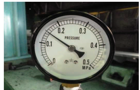
加圧完了 (0.15 MPa, 1 時間保持後, 漏水なし)
