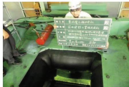
加圧完了 (0.15 MPa, 1 時間保持後, 漏水なし)
