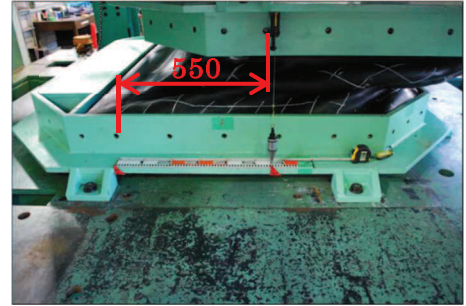
せん断変形後状況 (せん断 550mm)
