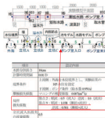
図 1.4-22 解析モデル (上)、解析条件 (下)
