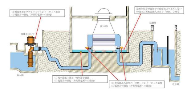
図 3-30 タービン建屋における循環水系配管からの溢水の評価方針の概要
