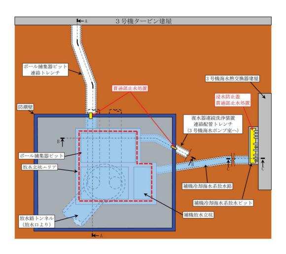
図 3-18 第 3 号機 放水立坑 浸水対策配置図 (平面図)
