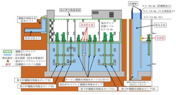
図 3-11 第 3 号機 海水熱交換器建屋 浸水対策配置図 (左: A-A 断面図 右: B-B 断面図)
