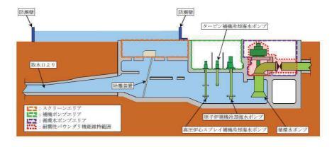
図 3-38 海水ポンプ室循環水ポンプエリアの耐震性バウンダリ機能維持範囲 (断面図)
