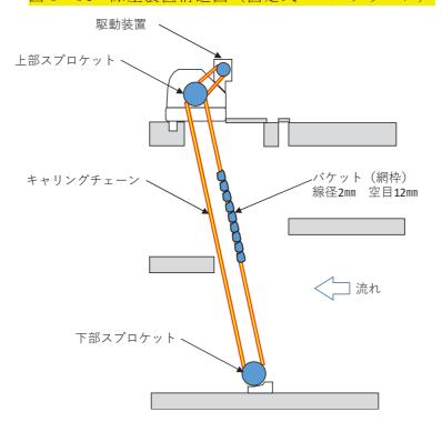
図 3-55 除塵装置構造図 (バケット型スクリーン)
