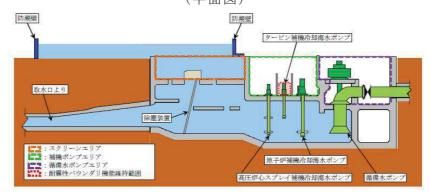
図 3-40 海水ポンプ室補機ポンプエリアの耐震性バウンダリ機能維持範囲 (断面図)
