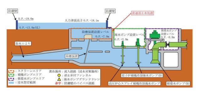
図 3-4 第 2 号機 海水ポンプ室 浸水対策配置図 (A-A 断面図)
