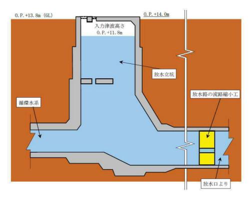
図 3-17 第 1 号機 放水立坑 浸水対策配置図 (A-A 断面図)
