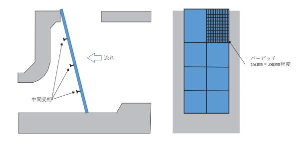
図 3-54 除塵装置構造図 (固定式バースクリーン)
