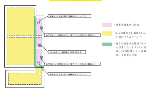
注記 \*1 浸水防護重点化範囲(浸水を想定するエリア)については、静的な耐震Sクラス設備(タンク、配管、手動弁)のみが存在するエリアであり、耐震Sクラス設備(タンク、配管、手動弁)の浸水による影響を評価し、機能喪失しないことを確認している。
