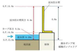
※津波による補機放水の溢水量を考慮した場合の浸水深は 0.18m だが、補機冷却海水系放水ピットが、海水ポンプ室補機ポンプエリアに近く、流れの影響を受けることで、一時的にカーブ高さ (0.2m) を超える可能性を考慮し、敷地高さ (0.P.13.8m) に対して天端高さが 0.P.14.4m (敷地からの高さ 0.6m) となる浸水防止壁を設置。
