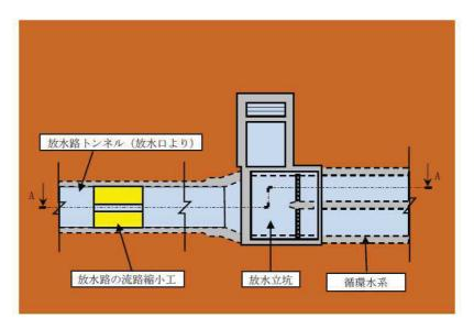
図 3-16 第 1 号機 放水立坑 浸水対策配置図 (平面図)
