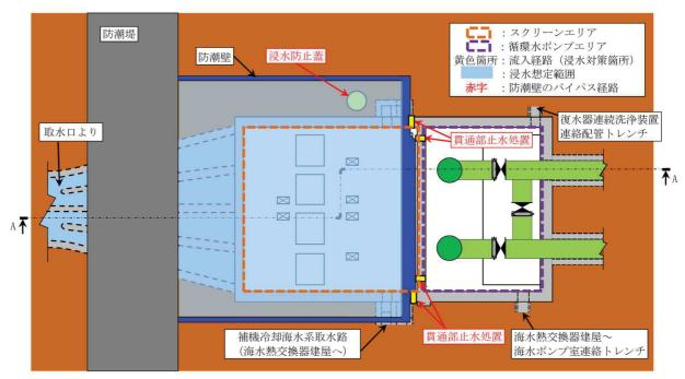
図 3-8 第 3 号機 海水ポンプ室 浸水対策配置図 (平面図)
