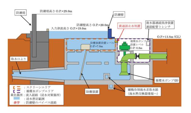
図 3-9 第3号機 海水ポンプ室 浸水対策配置図 (A-A 断面図)
