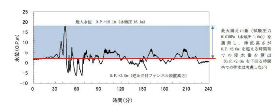
図 3-29 逆止弁付ファンネルからの浸水量評価適用図 (第 2 号機 海水ポンプ室補機ポンプエリア)
