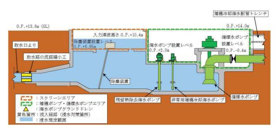
図 3-7 第1号機 海水ポンプ室 浸水対策配置図 (A-A 断面図)
