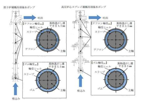
※1:ポンプ起動時に水没状態である箇所に適用
