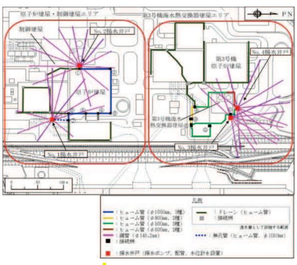
図 4-1 ドレーン及び接続桝 配置概要図
