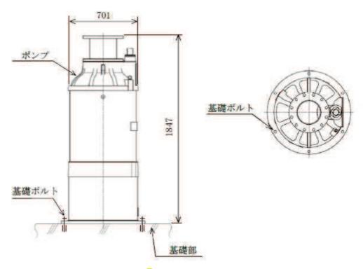
図 4-<mark>7</mark> 揚水ポンプ構造図
