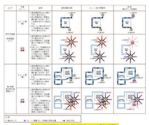
図 4-5 部分閉塞発生時の流下経路(ヒューム管及び鋼管)
