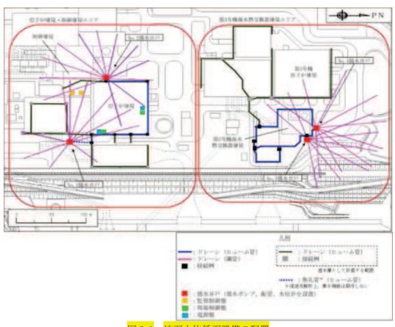
図 3-1 地下水位低下設備の配置
