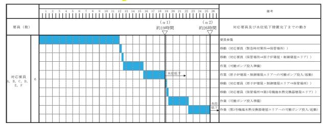
図 6-4 地下水位低下設備機能喪失後の水位低下措置時間 (α1及びα2)
