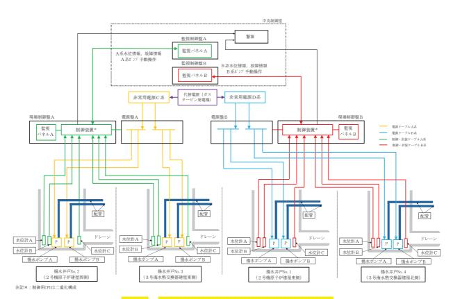
図 3-3 地下水位低下設備の制御及び電源系統図
