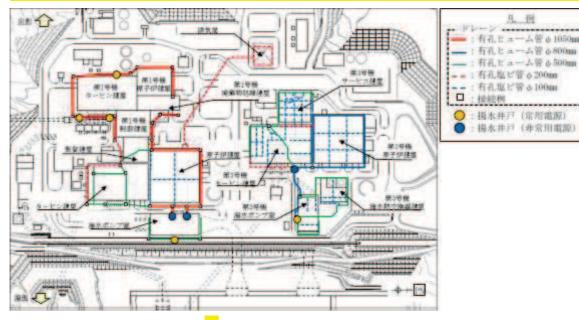
図 4-11 既設の地下水位低下設備の配置
