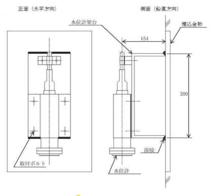
図 4-8 水位計の構造図
