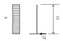
図 4-3 せん断力算定モデル化(1)
