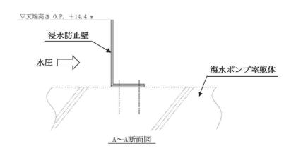
図 2-1 浸水防止壁の設置位置図
