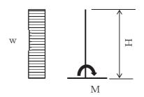
図 4-1 曲げモーメント算定モデル化(1)
