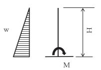
図 4-2 曲げモーメント算定モデル化(2)
