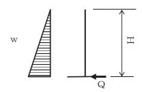
図 4-4 せん断力算定モデル化(2)
