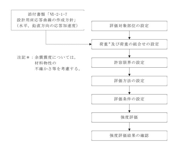
図 2-2 強度評価フロー
