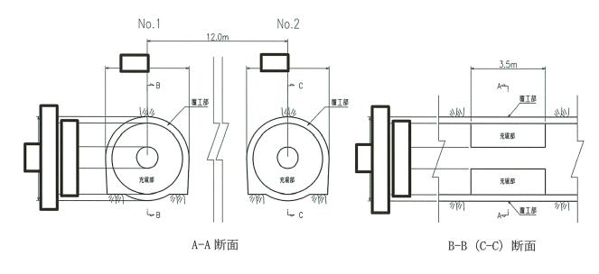
図 2-2(2) 取放水路流路縮小工 (第1号機取水路) (No. 1), (No. 2) 断面図
