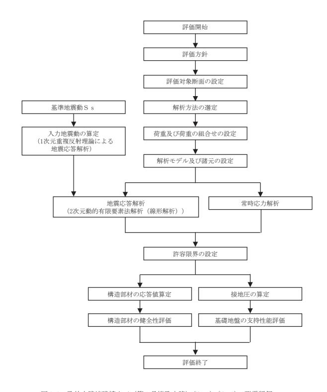
図 2-3 取放水路流路縮小工 (第1号機取水路) (No.1), (No.2)の耐震評価フロー
