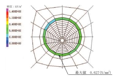
図 3-6 覆工部の引張強度における照査値最大となる時刻の応力分布図 (Ss-F3 (-+), t=27.64s) (解析ケース①:基本ケース)
