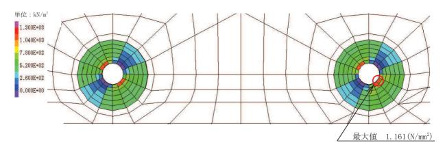
図 3-7 充填部の引張強度における照査値最大となる時刻の応力分布図 (Ss-F3(-+), t=27.64s)
