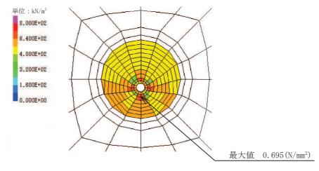
図 3-9 充填部のせん断強度における照査値最大となる時刻の応力分布図 (S s - F 3 (++), t=27.64s) (解析ケース①: 基本ケース)
