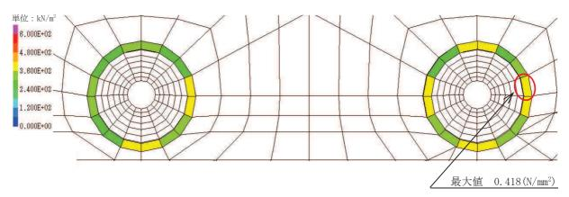
図 3-8 覆工部のせん断強度における照査値最大となる時刻の応力分布図
