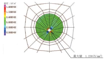
図 3-7 充填部の引張強度における照査値最大となる時刻の応力分布図  $(S\ s-F\ 3\ (-+),\ t=27.64s)$
