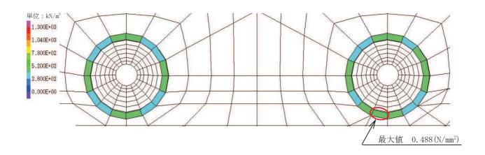
図 3-6 覆工部の引張強度における照査値最大となる時刻の応力分布図 (Ss-F3(-+), t=27.64s)
