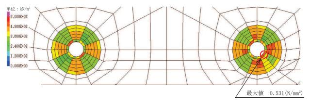
図 3-9 充填部のせん断強度における照査値最大となる時刻の応力分布図
