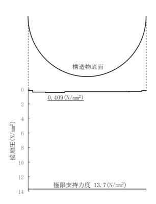
図 3-10 最大接地圧の分布図 (Ss-F3 (-+))
