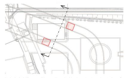
図 3-1 取放水路流路縮小工 (第1号機取水路) (No.1), (No.2)の評価対象断面位置図
