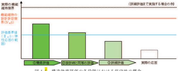
図 4-5 構造強度評価の各段階における保守性の概念
