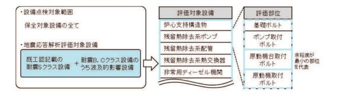
図 4-1 評価対象選定の考え方の概要図
