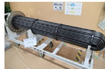
蒸気発生器の点検整備
