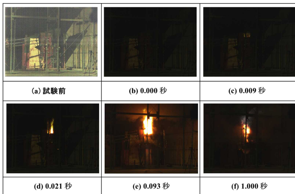
図 2.2.3.3 図 2.2.3.2 の各圧力(a~f)における高速度ビデオカメラの映像 Fig. 2.2.3.3 High-speed video camera images at each pressure (a~f) in the Fig. 2.2.3.2
