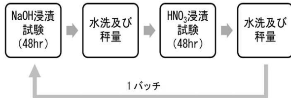
図 NaOHとHNO 3 との交互浸漬試験のフロー(除染作業を模擬)
