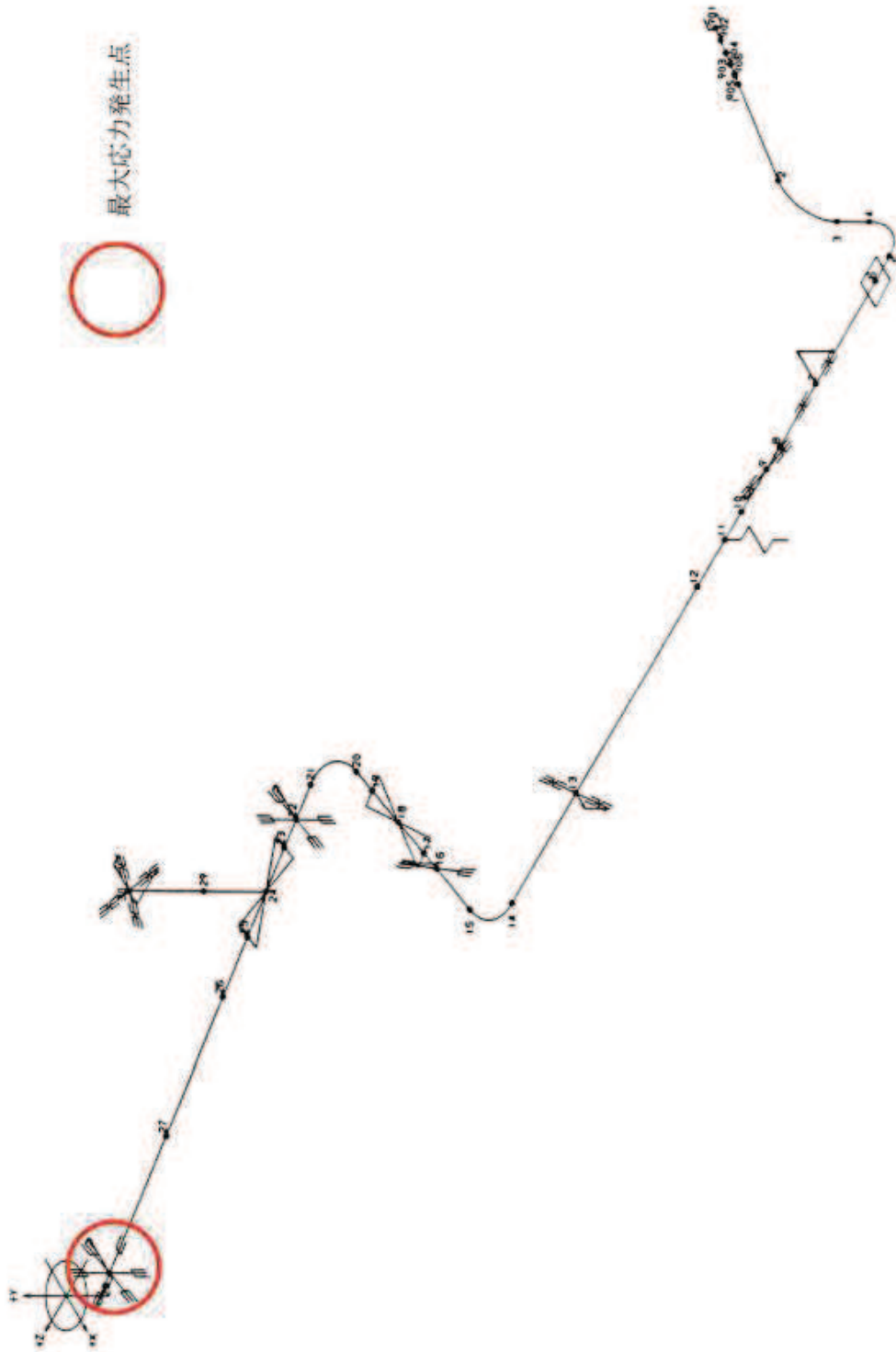
図 13 残留熱除去系配管 (RHR-001 A プラント)
