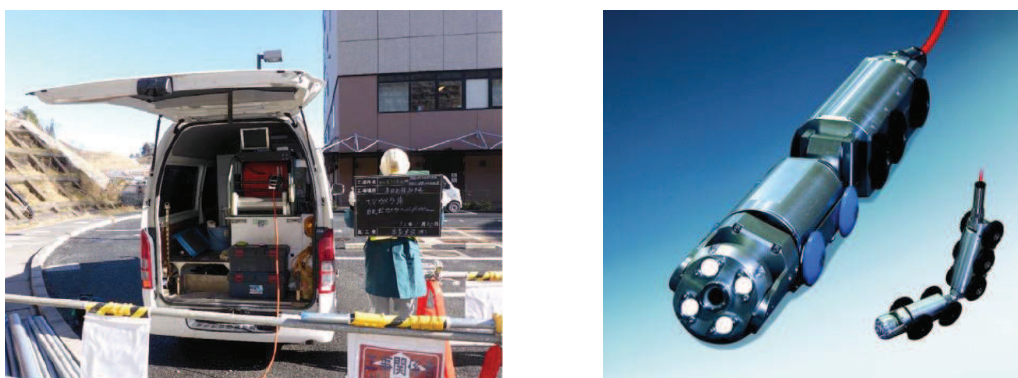
図 9-5 自走式 TV カメラの外観イメージ
