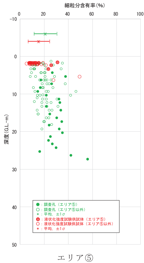
図 4.2-16(2) 盛土の液状化強度試験供試体と敷地内調査箇所の新粒分含有率 (エリア別比較)
