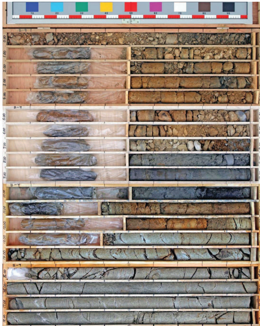
図 1-52(2) ボーリングコア写真 (23B-9) (盛土：深度 0～7.10m, 旧表土：深度 7.10～13.38m)
