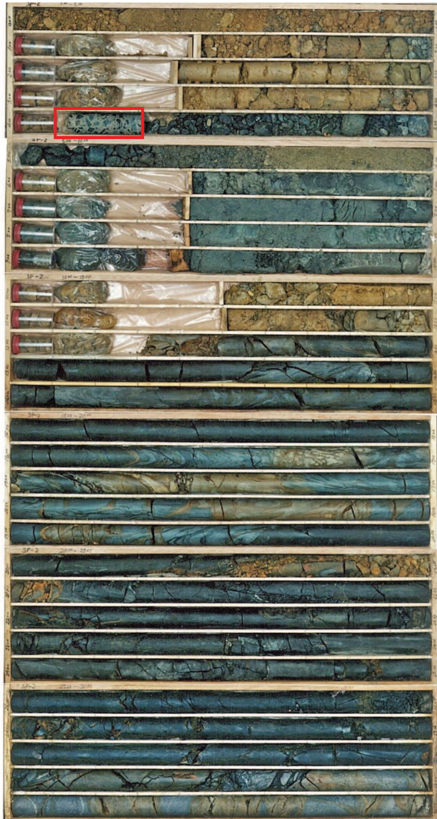
図 1-40(2) ボーリングコア写真 (SP-2) (盛土：深度 0～5.60m, 旧表土：深度 5.60～12.18m)
