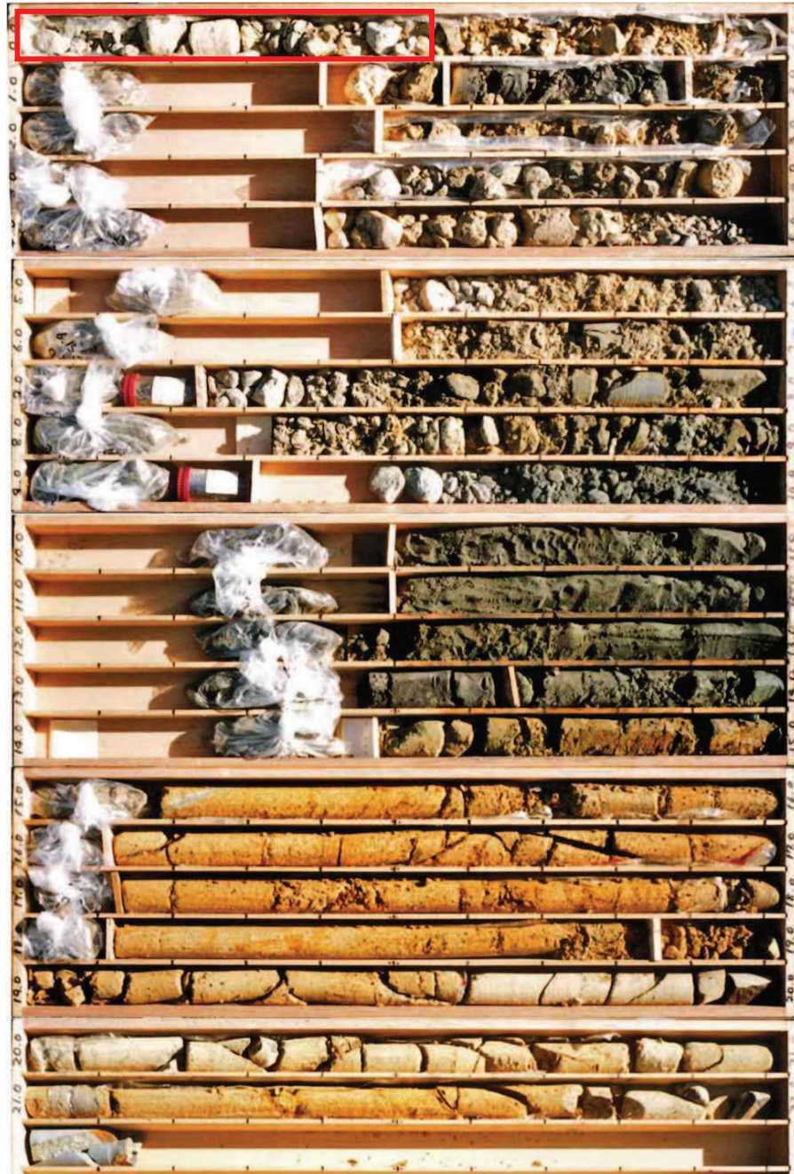
図 1-41(2) ボーリングコア写真 (Fs-1) (旧表土 : 深度 0~13.65m)
