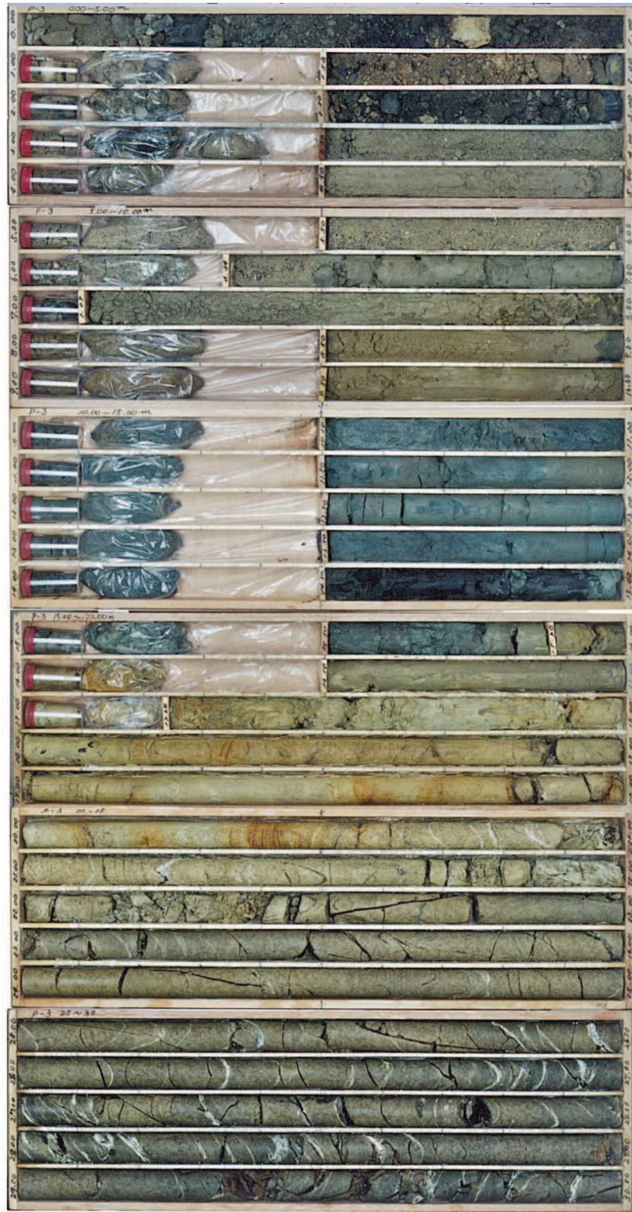
図 1-38(2) ボーリングコア写真 (P-3) (盛土 : 深度 0~3.30m, 旧表土 : 深度 3.30~18.18m)
