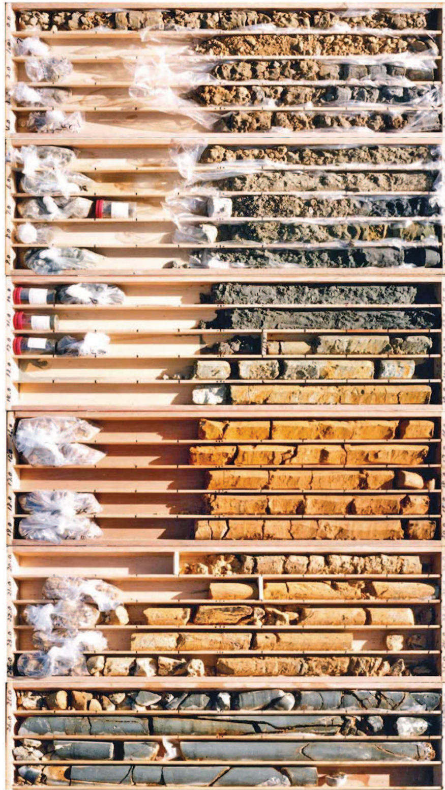
図 1-42(2) ボーリングコア写真 (Fs-2) (旧表土：深度 0～13.78m)
