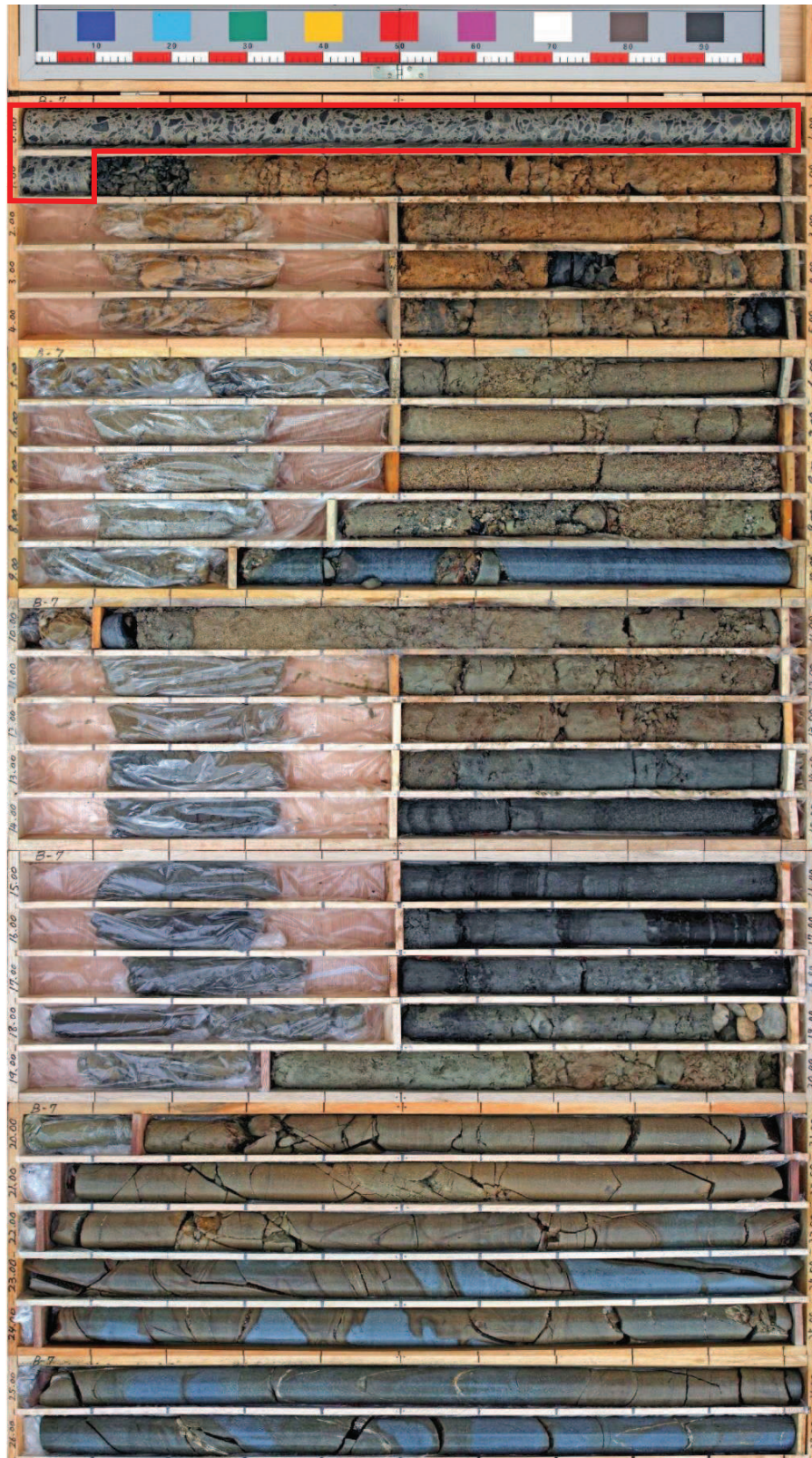
図 1-51(2) ボーリングコア写真 (23B-7) (盛土 : 深度 0~5.30m, 旧表土 : 深度 5.30~19.95m)
