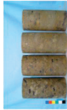
液状化強度試験供試体 (A-4 : 試験前)
