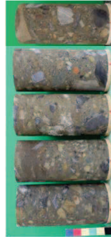
液状化強度試験供試体 (A-2 : 試験前)
