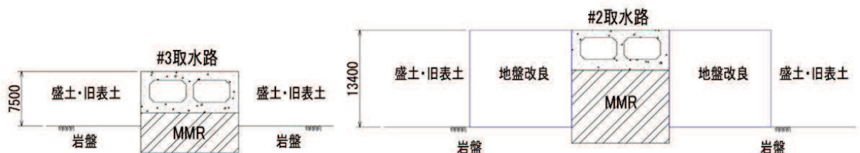
図 8.6-7 2号機取水路及び3号機取水路の構造
