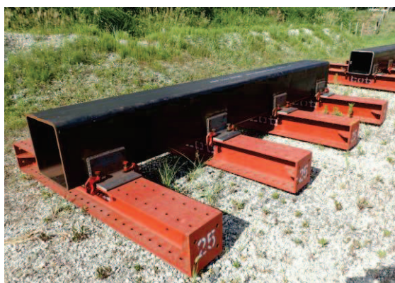
写真1 模擬建屋構造材設置
