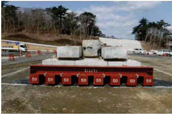
写真1 模擬がれき設置
