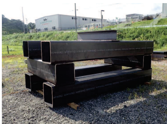
写真1 模擬がれき設置
