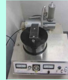
研磨片・薄片及び条線観察から最新面と確定した試料の蒸着
