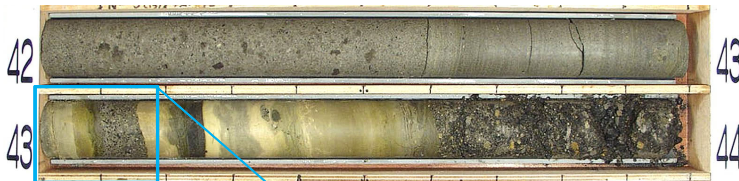
ボーリングコア写真
