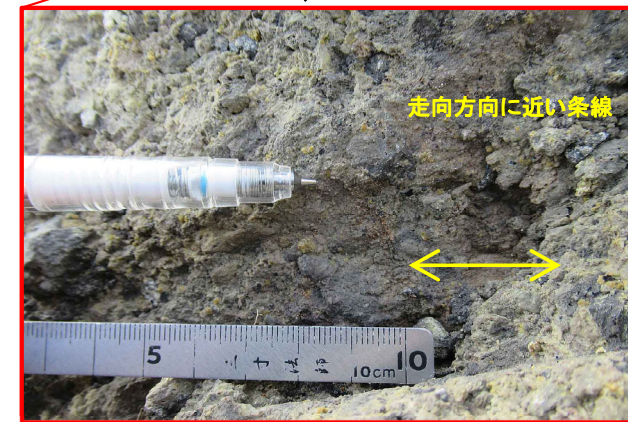
高角の変位を伴う不連続面a ・ 走向・傾斜: N43° E, 84° E ・ 走向方向に近いやや不明瞭な条線有り (プランジ角9° N)
