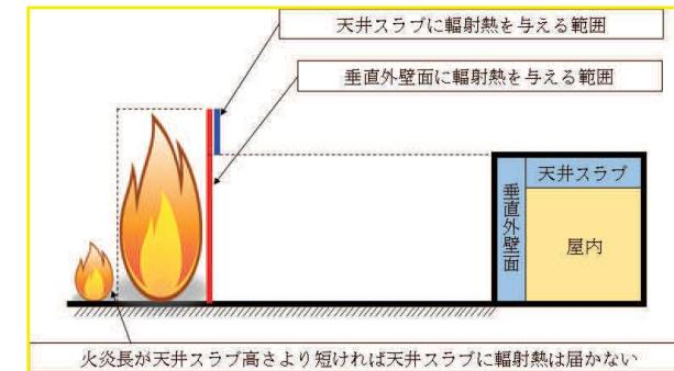
図 2.1.1-3 天井スラブの評価概念図
