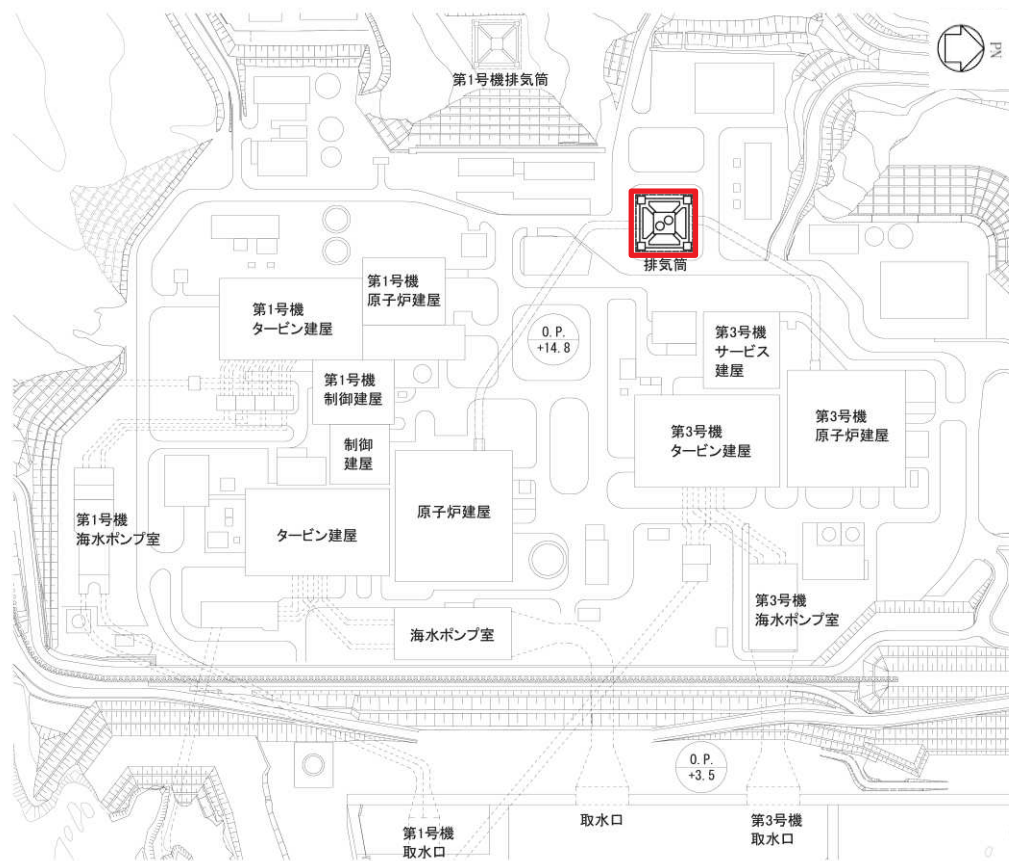
図 2-1 排気筒の設置位置
