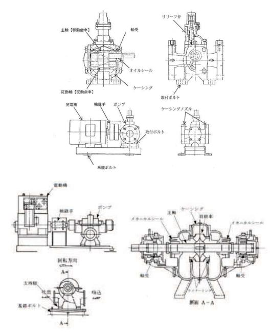
図3 遠心式ポンプ及びギヤ式ポンプの構造概要図
