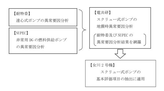
図5 地震時異常要因分析の適用 (スクリュー式ポンプ)
