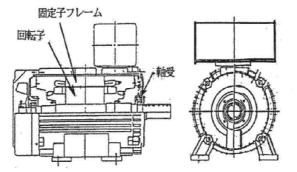
図3 電動機(横形ころがり軸受)の構造概要図
