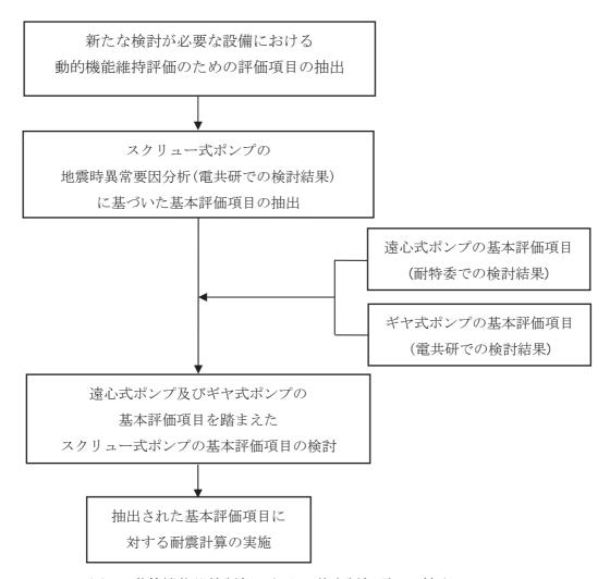
図4 動的機能維持評価のための基本評価項目の抽出フロー
