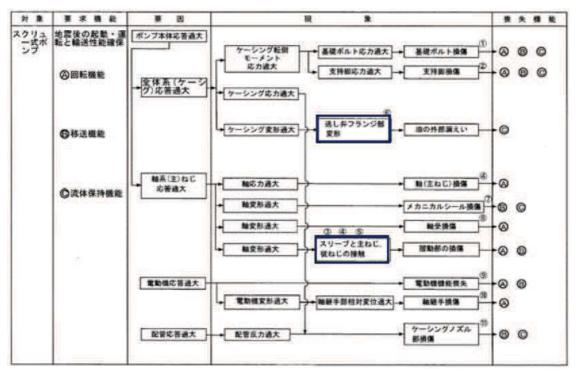
図6 スクリュー式ポンプの地震時異常要因分析図
