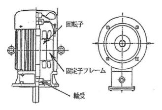
図2 電動機(立形すべり軸受)の構造概要図
