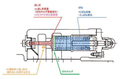
図2 逃がし弁の構造図
