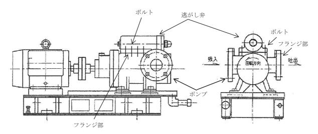
図1 燃料移送ポンプ構造概要図
