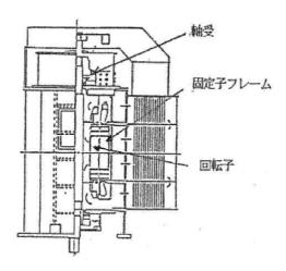
図1 電動機(立形ころがり軸受)の構造概要図
