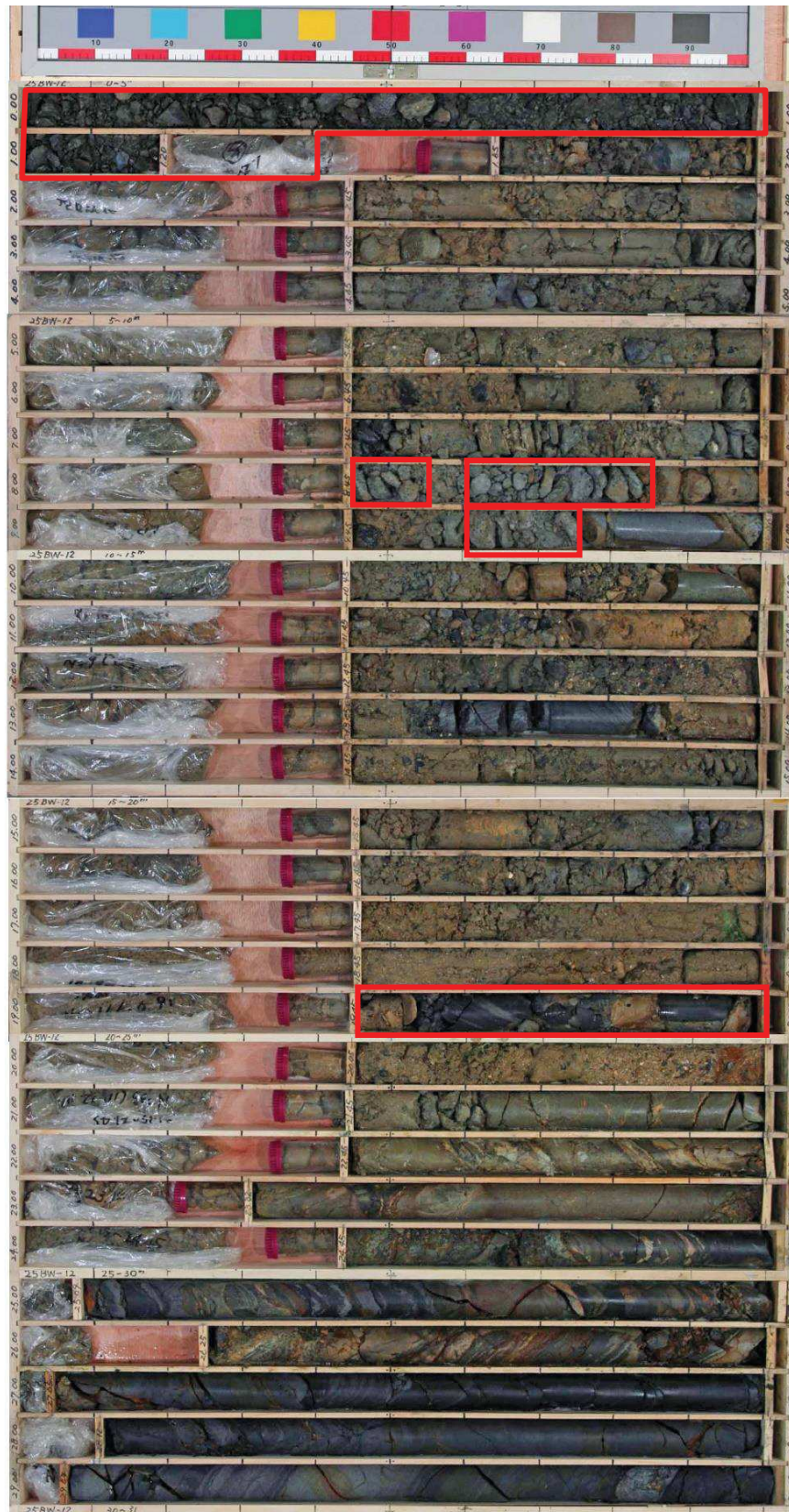
図 1-15(2) ボーリングコア写真 (25BW-12) (盛土：深度 0～21.00m, 旧表土：深度 21.00～21.60m)
