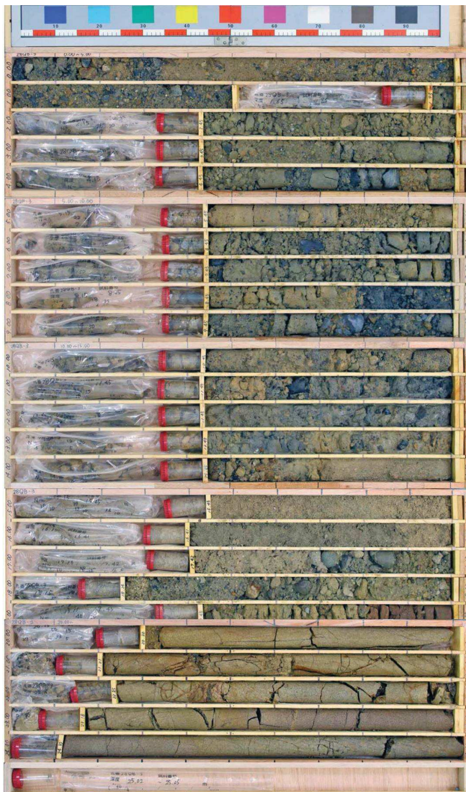
図 1-30(2) ボーリングコア写真 (28QB-3) (盛土：深度 0～14.70m, 旧表土：深度 14.70～19.80m)
