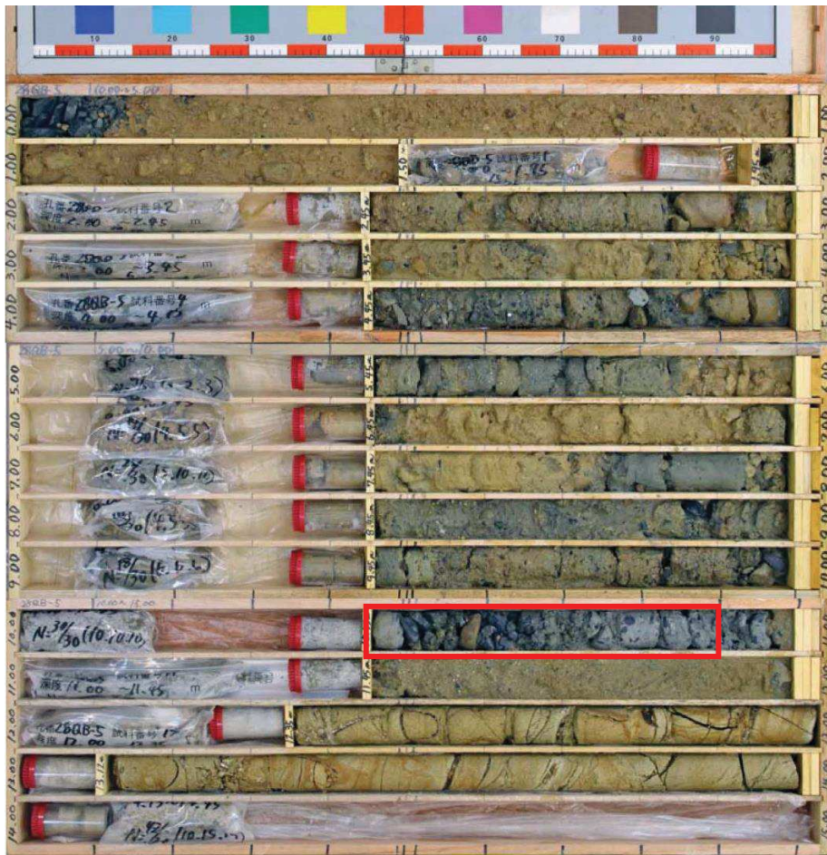
図 1-33(2) ボーリングコア写真 (28QB-5) (盛土 : 深度 0~11.45m, 旧表土 : 深度 11.45~12.00m)
