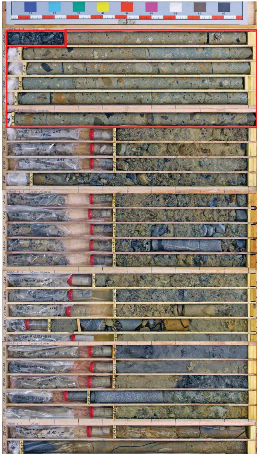
図 1-31 (2) ボーリングコア写真 (28QB-4-1) (盛土 : 深度 0~19.45m, 旧表土 : 深度 19.45~25.50m)
