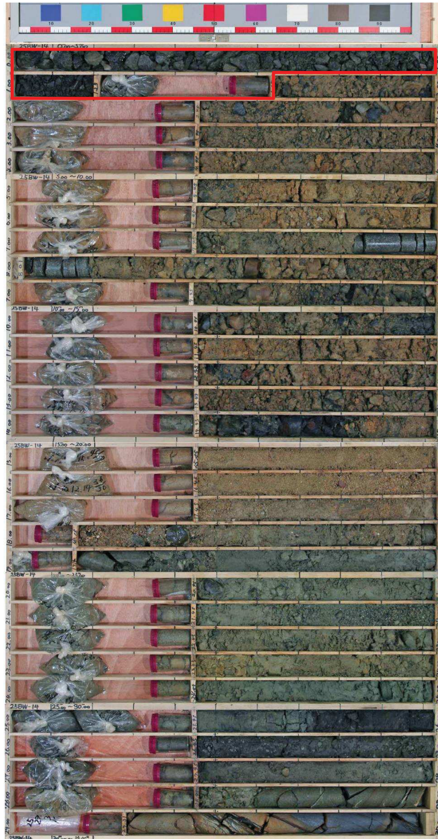
図 1-17(2) ボーリングコア写真 (25BW-14) (盛土：深度 0～14.90m, 旧表土：深度 14.90～28.60m)
