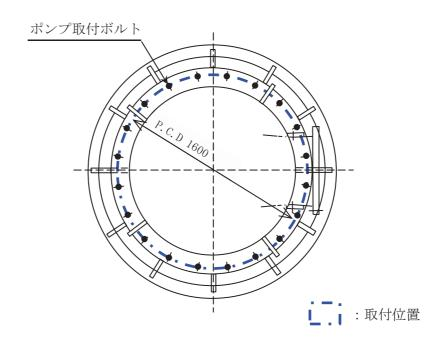
図 2-3 ポンプ取付ボルト取付位置
