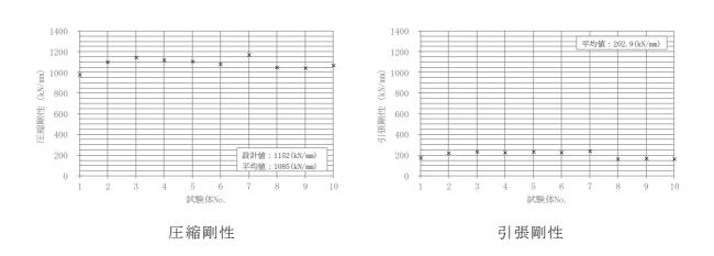
図 5-12 圧縮/引張剛性確認試験結果(算出值)
