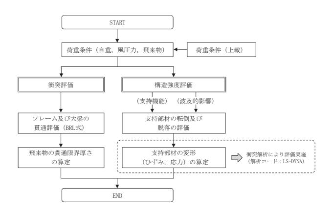
図 1-1 支持部材の強度評価フロー図
