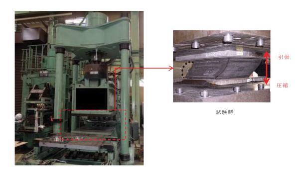
図 5-9 試験装置 (2MN 二軸試験機) の外観
