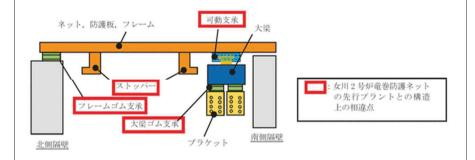
図7 竜巻防護ネットの構造 (イメージ)
