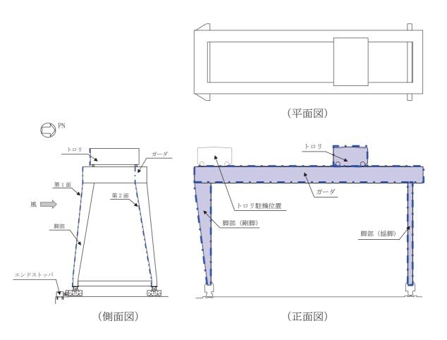
図 2-18 海水ポンプ室門型クレーン受圧面
