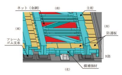
図 2-1 防護板概要図(1/2)
