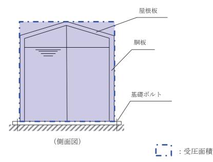
図 2-15 復水貯蔵タンク受圧面
