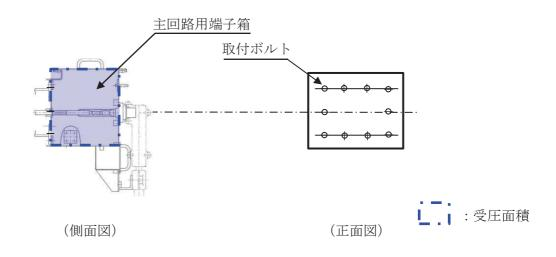
図 2-6 主回路用端子箱受圧面
