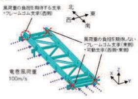
図7 竜巻風荷重に対する評価モデル図
