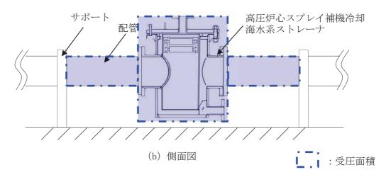
図 2-14 高圧炉心スプレイ補機冷却海水系ストレーナ受圧面
