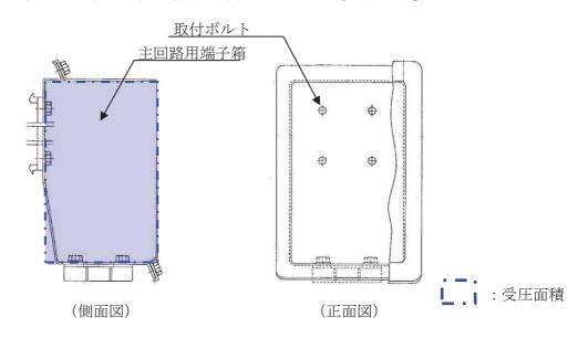
図 2-12 主回路用端子箱受圧面
