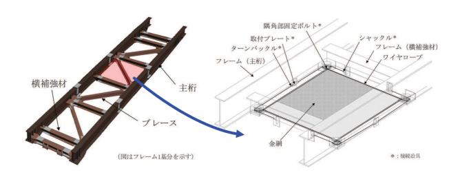
図 2-3 ネットのフレーム取り付け概要図
