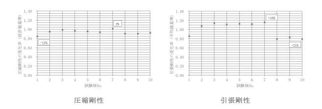
図 5-13 圧縮/引張剛性確認試験結果(変化率)
