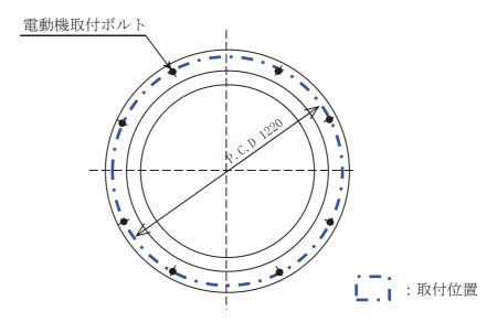
図 2-2 電動機取付ボルト取付位置
