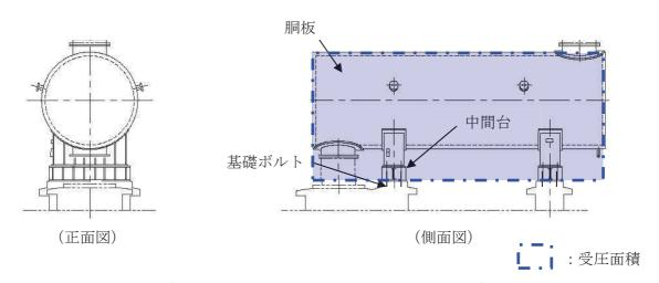
図 2-16 非常用ディーゼル発電設備及び高圧炉心スプレイ系ディーゼル発電設備 排気消音器受圧面(軸直角方向)
