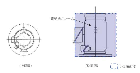
図 2-11 電動機フレーム受圧面
