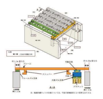
図2 竜巻防護ネットの概要図
