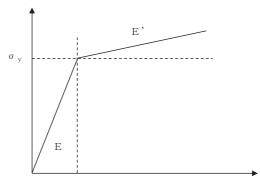
図 6-4 応力-ひずみ関係の概念図
