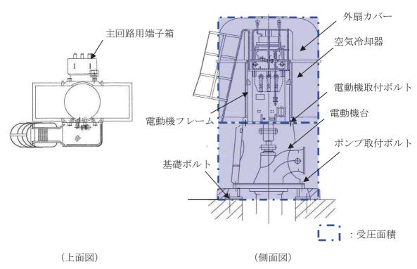
図 2-1 原子炉補機冷却海水ポンプ受圧面
