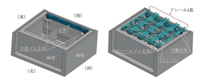
図 2-5 フレーム及び大梁の配置概要図
