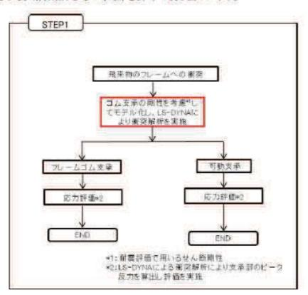
図1 STEP1 構造成立性確認フロー
