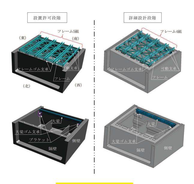
図 4-1 竜巻防護ネット構造概要比較
