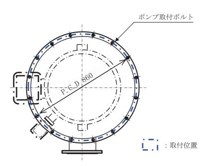
図 2-9 ポンプ取付ボルト取付位置
