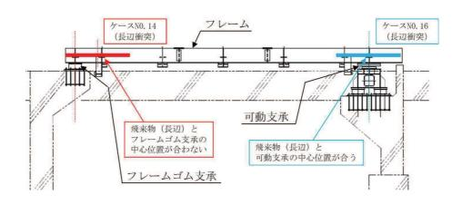
図 6-6 飛来物衝突位置の概要(長辺衝突)
