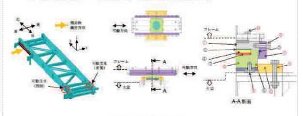
図4 可動支承の構造図
