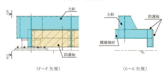
図 2-1 防護板概要図(2/2)
