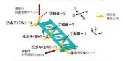
図2 飛来物衝突位置及び解析モデル図 (STEP2-1)
