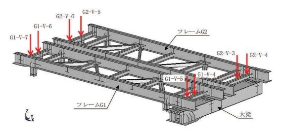
(横補強材への飛来物衝突)
