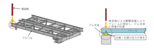
図 5-1 竜巻防護ネットへの飛来物衝突のイメージ
