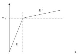
図 5-6 応力-ひずみ関係の概念図
