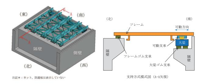
図 2-6 竜巻防護ネットの支持構造模式図
