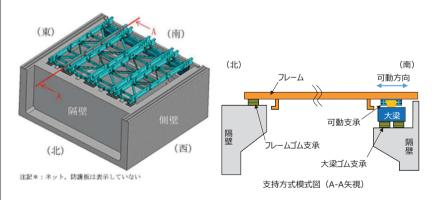
図 2-5 竜巻防護ネットの支持構造模式図
