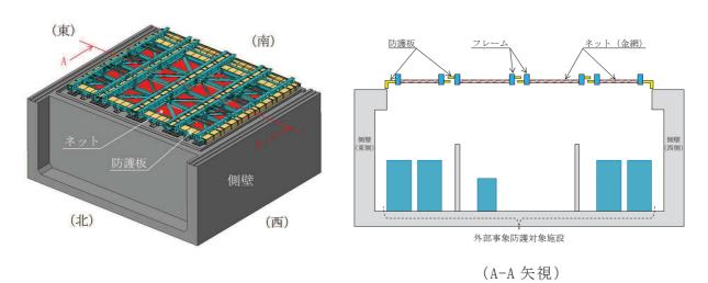
図 2-4 防護板の配置概要図
