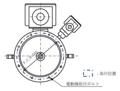
図 2-8 電動機取付ボルト取付位置
