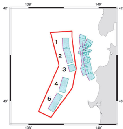
図-2 日本海中部地震の震源域近傍の断層モデル (赤枠は対象とする断層群)
