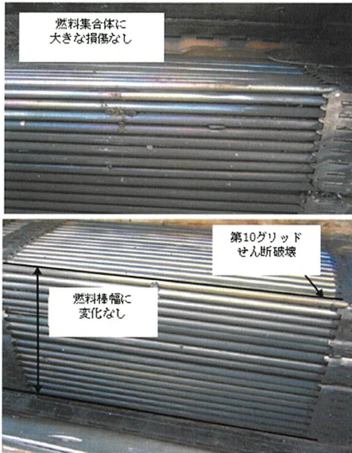
写真(ロ)A 付 1- 17 QTU-1 試験後の模擬燃料集合体外観
