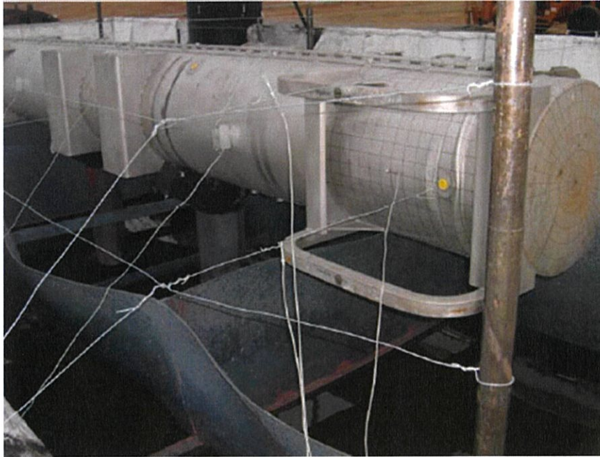
図(ロ)B 付 1-2 耐火試験用スタンド
