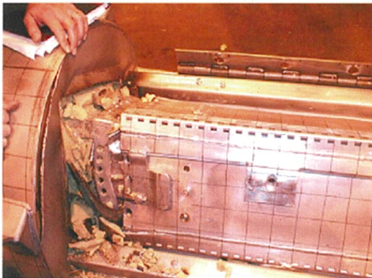
写真(ロ)A 付 1- 13 Prototype-2 試験④～⑥後の輸送容器下部ノズル側の状況
