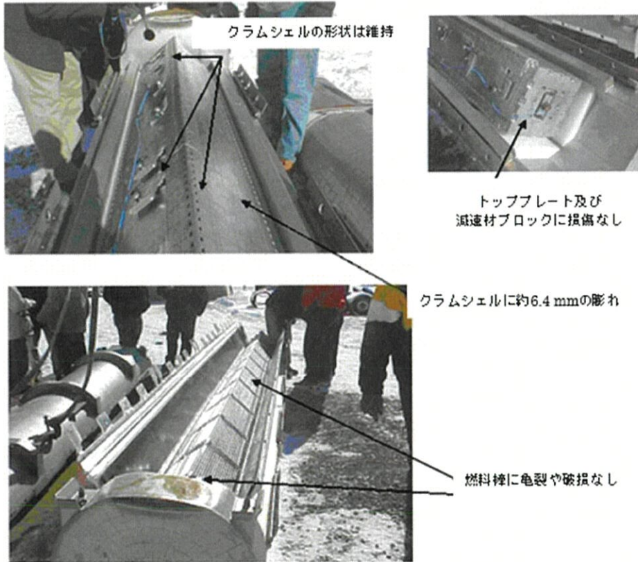
写真(ロ)A 付 1- 4 Prototype-1 試験①後の輸送容器内部の状況
