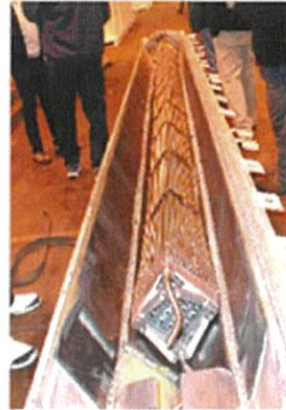
写真(ロ)A 付 1- 12 Prototype-2 試験④～⑥後の輸送容器内外部の状況
