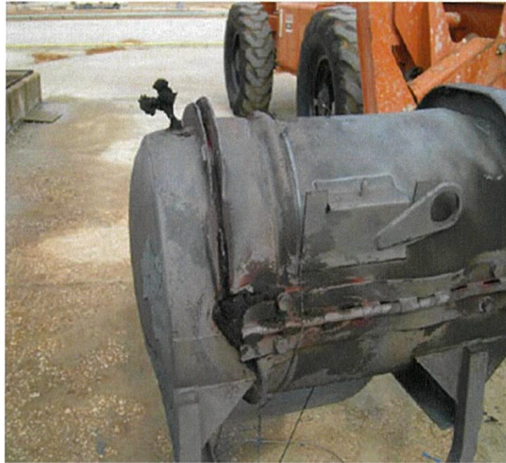
図(ロ)B 付 1- 16 外容器フランジ部のポリウレタン炭化物
