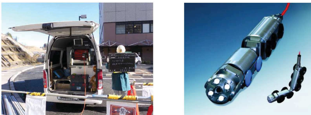
図 9-5 自走式 TV カメラの外観イメージ
