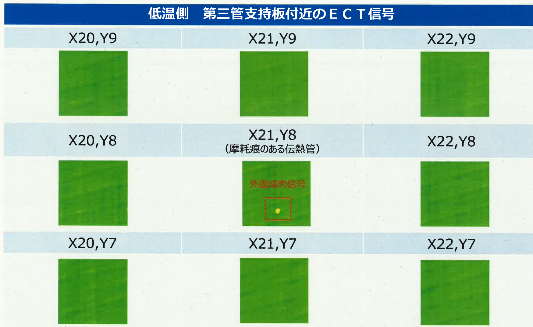
摩耗痕のある伝熱管と隣接した伝熱管の E C T 結果 (MIX:C-SG(X21,Y8)の例)
