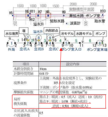
図 1.4-22 解析モデル (上)、解析条件 (下)
