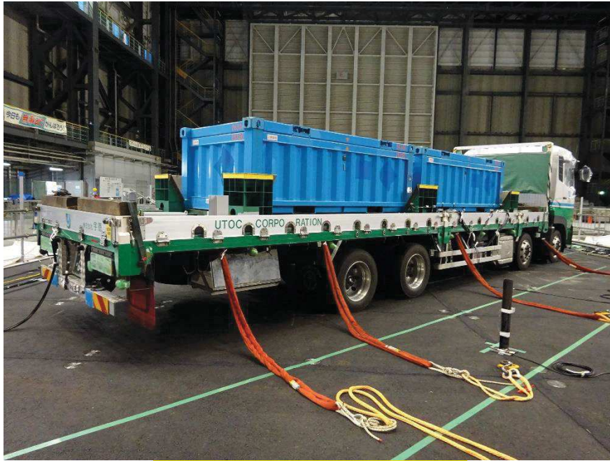
図9 加振試験時のLLW輸送車両
