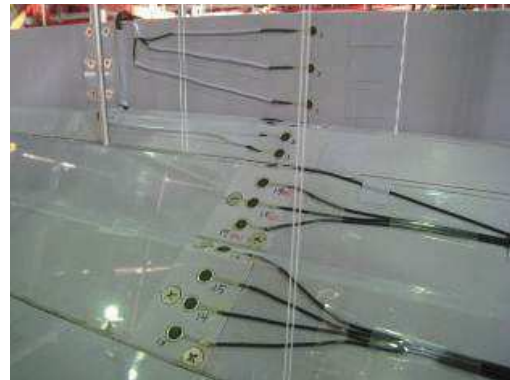
波圧計設置(盛土・防潮堤前面)
