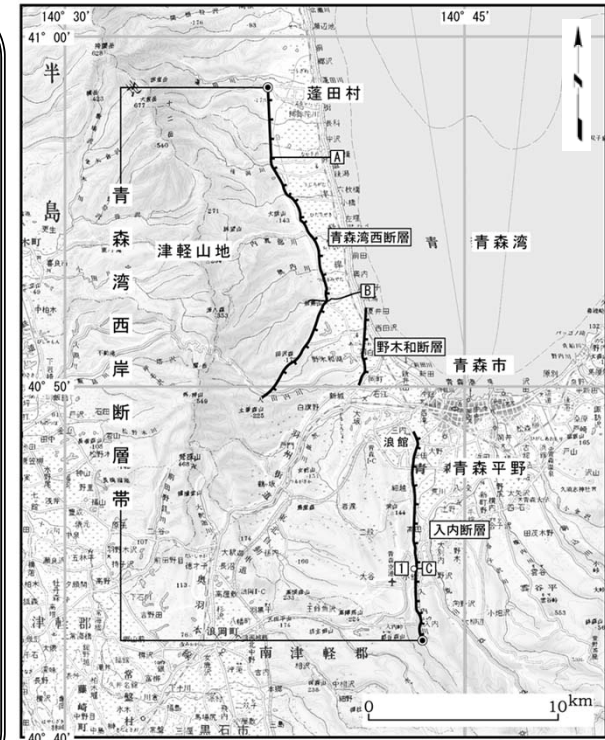
1 : 小館地点 A-C : 反射法弾性波探査測線 (文献1) ● : 断層帯の北端と南端 ○ : 断層帯の位置は文献2に基づく。 基図は国土地理院発行数値地図200000「青森」を使用。
