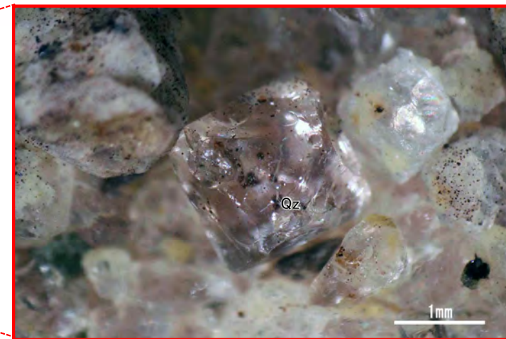
写真1-3 同左実体鏡拡大写真 粒径2mm程度の大きな石英粒子(いわゆる算盤玉状の結晶形を呈する)が認められる。
