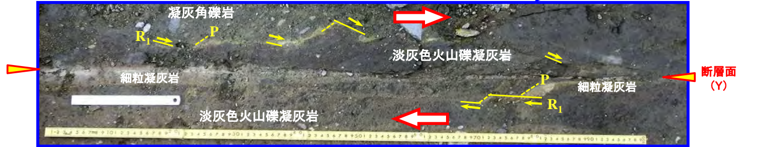
易国間層中の直線的な断層面とその近傍の右横ずれセンスを示す複合面構造
