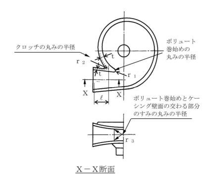
図 3-4-1 うず巻ポンプのケーシング各部形状 (告示第 5 0 1 号第 77 条第 7 項図 2 又は設計・建設規格 図 PMC-3340-1(b))
