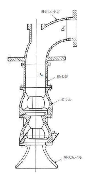
図 4-1 軸垂直割りケーシングをもった多段の立形ポンプの例 (設計・建設規格 図 PMD-3310-7)
