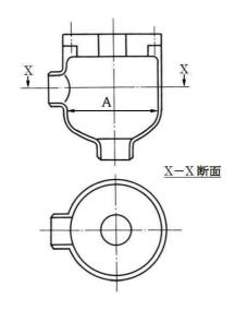
図 3-2 ターボポンプの例 (設計・建設規格 図 PMC-3320-5)
