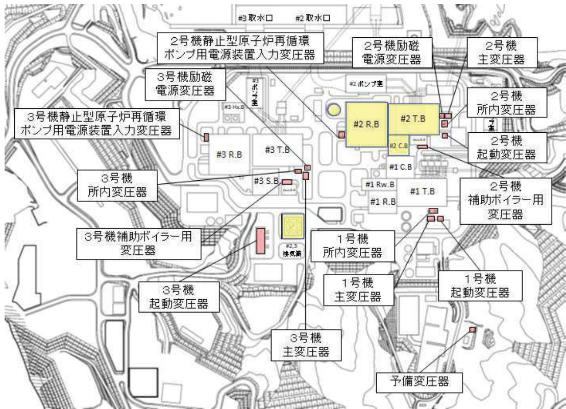
図 2.1.2-3 危険物貯蔵施設等配置図（法令に基づく届出対象ではない設備）
