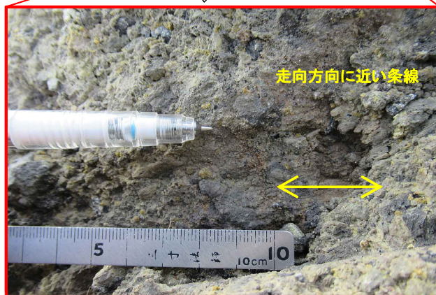
高角の変位を伴う不連続面a ・ 走向・傾斜: N43° E, 84° E ・ 走向方向に近いやや不明瞭な条線有り(プランジ角9° N)
