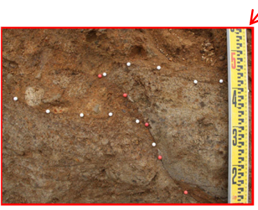
pd系弱面の変位が段丘堆積物中にまで達する部分(右: 解釈線有り, 左: 解釈線なし)
