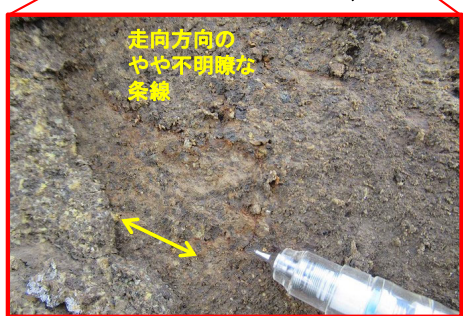
高角の変位を伴う不連続面a ・強風化部 ・走向・傾斜:N37° E, 60° W ・走向方向のやや不明瞭な条線有り(プランジ角10° S)
