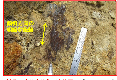
低角の変位を伴う不連続面c ・強風化部 ・走向・傾斜:N35° E, 24° N ・傾斜方向の明瞭な条線有り(プランジ角24° N)
