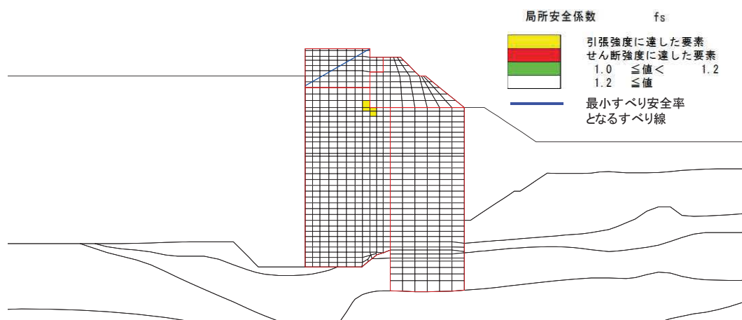
図 4.1-5 (1) 背面補強工の最小すべり安全率時刻における局所安全係数分布 （断面①, S s - F 3 (-+), t=28.66s)
