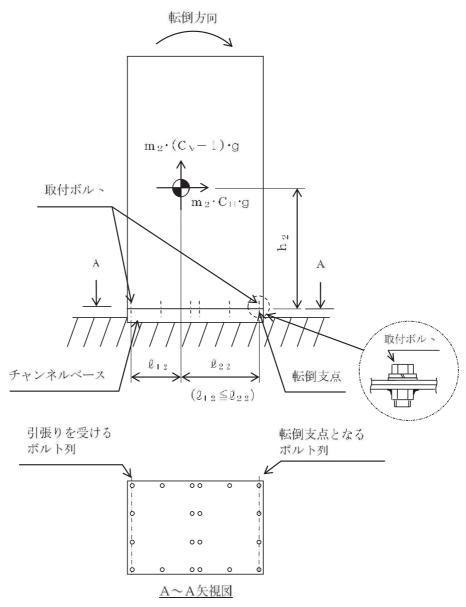
図 5-4(4) 計算モデル (直立形 長辺方向転倒 (1-C<sub>V</sub>)<0 の場合)
