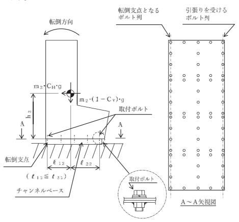
図 5-3(1) 計算モデル (ベンチ形 短辺方向転倒 (1-C<sub>V</sub>)≥0の場合)
