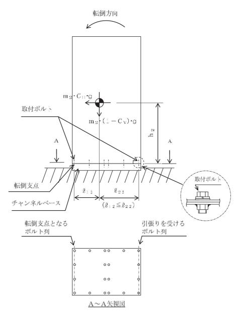
図 5-4(3) 計算モデル (直立形 長辺方向転倒 (1-C<sub>V</sub>)≥0の場合)
