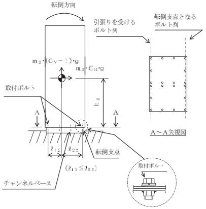
図 5-4(2) 計算モデル (直立形 短辺方向転倒  $(1-C_V)<0$  の場合)
