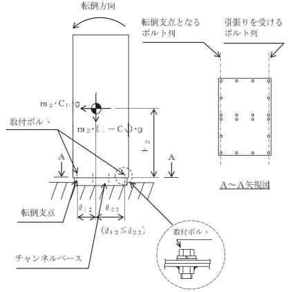
図 5-4(1) 計算モデル (直立形 短辺方向転倒 (1-C<sub>V</sub>)≥0の場合)
