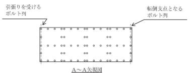
図 5-3(4) 計算モデル (ベンチ形 長辺方向転倒  $(1-C_{\rm V})<0$  の場合
