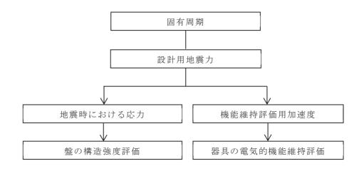
図 2-1 盤の耐震評価フロー
