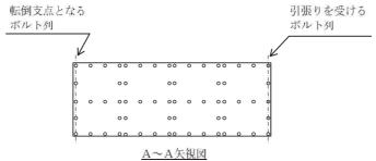
図 5-3(3) 計算モデル (ベンチ形 長辺方向転倒 (1-C<sub>V</sub>)≥0の場合)
