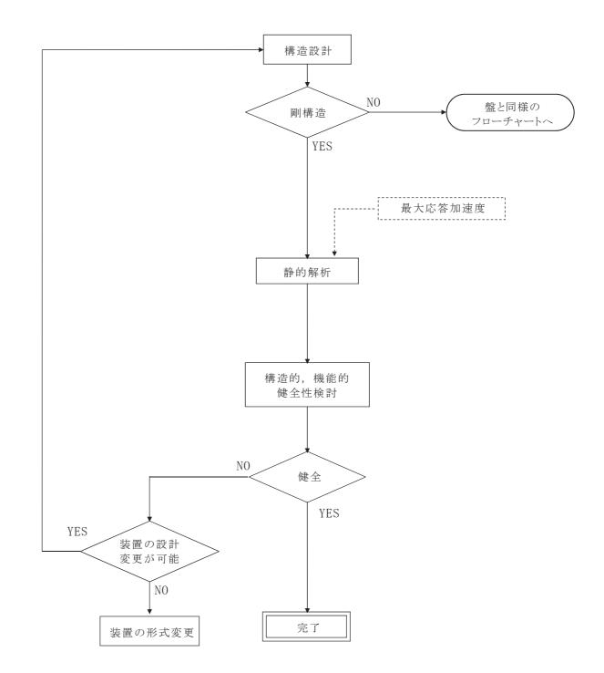
図 3-2 装置の耐震設計フローチャート
