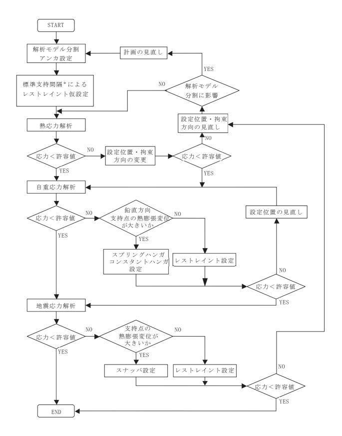
\*:配管の自重応力が 39.2MPa となる支持間隔を目安に軸直角 2 方向レストレイン トを仮設定
