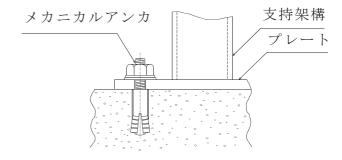
図 4-6 埋込金物の例
