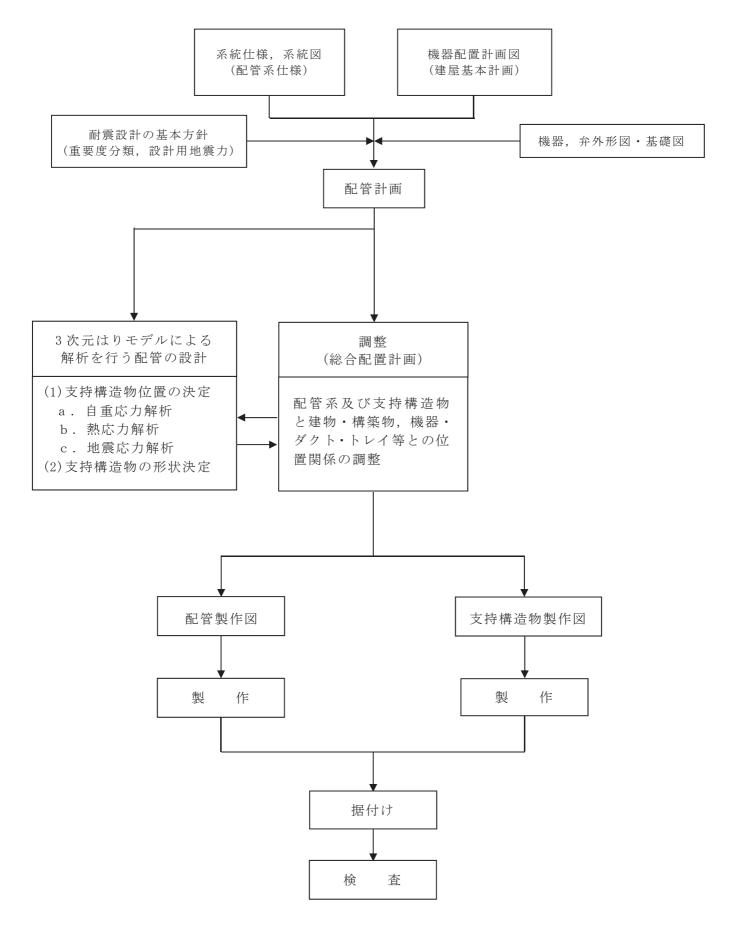
図 4-1 配管支持構造物設計フロー
