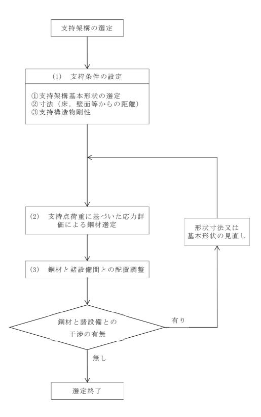
図 4-4 支持架構の設計フロー
