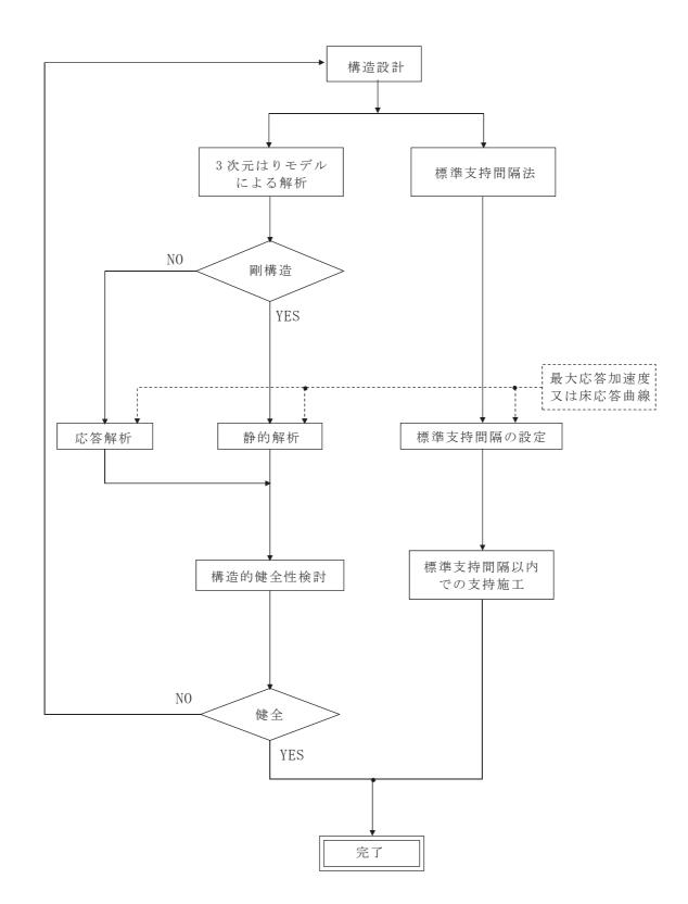
図 3-4 電路類の耐震設計フローチャート
