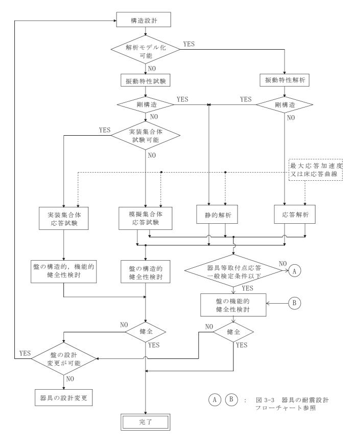
図 3-1 盤の耐震設計フローチャート
