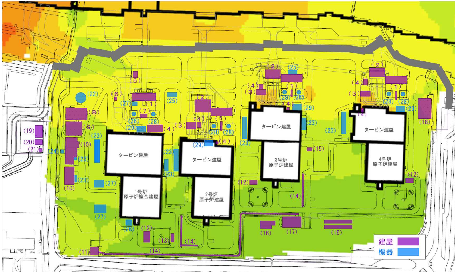
図 4.2-12-4-2 漂流物調査結果（発電所構内荒浜側防潮堤内敷地詳細）
