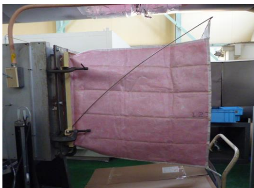
図1 バグフィルタの耐荷重試験の様子
