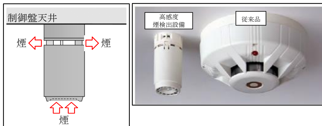
図 3-10 高感度煙検出設備の概要
