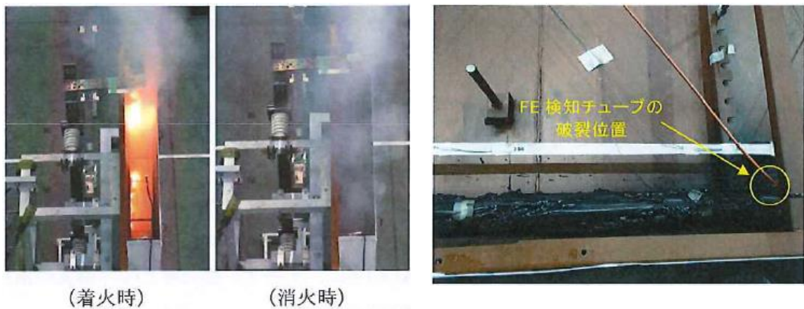
図 11 試験 V1 における発火・消火時の状態
