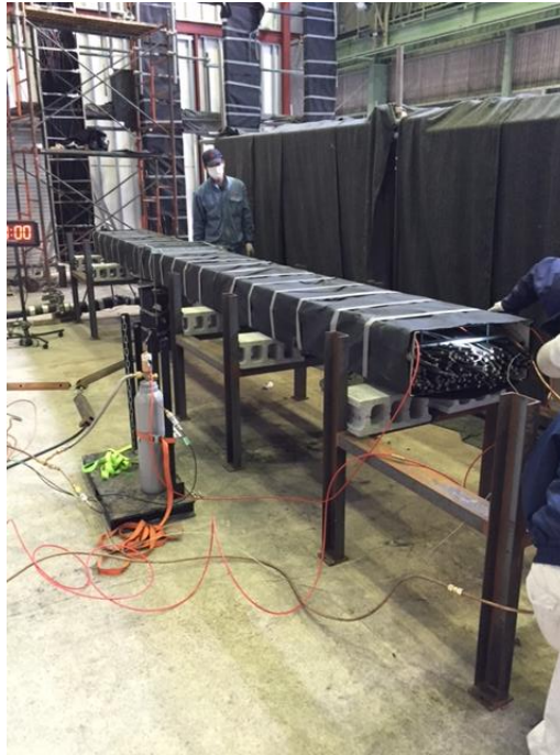
図 15 消火実証試験用（金属蓋なし）のケーブルトレイ外観
