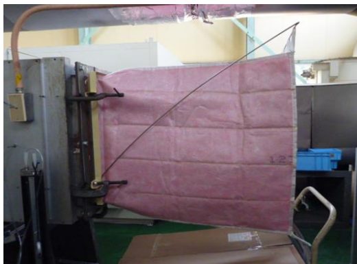
図1 バグフィルタの耐荷重試験の様子
