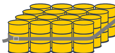
添図 5 - 1 - 2 平積み時の固縛対策 (固縛のみ)
