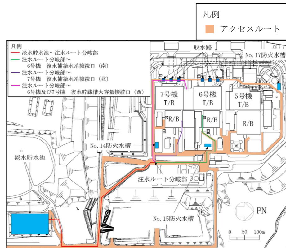
図 1-8 可搬型代替注水ポンプ屋外用 20m ホース 敷設ルート (ホース必要本数が最大となる場合)
