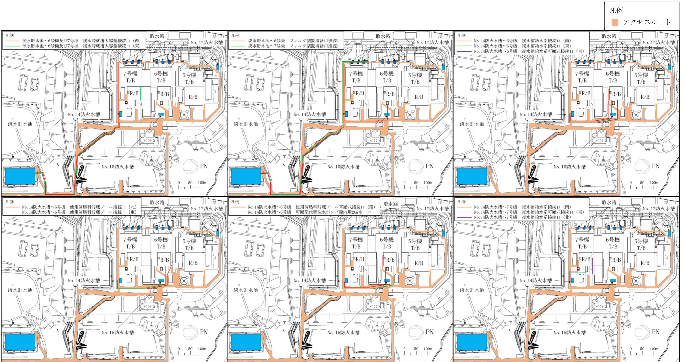
図 1-2 可搬型代替注水ポンプ屋外用 20m ホース 敷設ルート(2)
