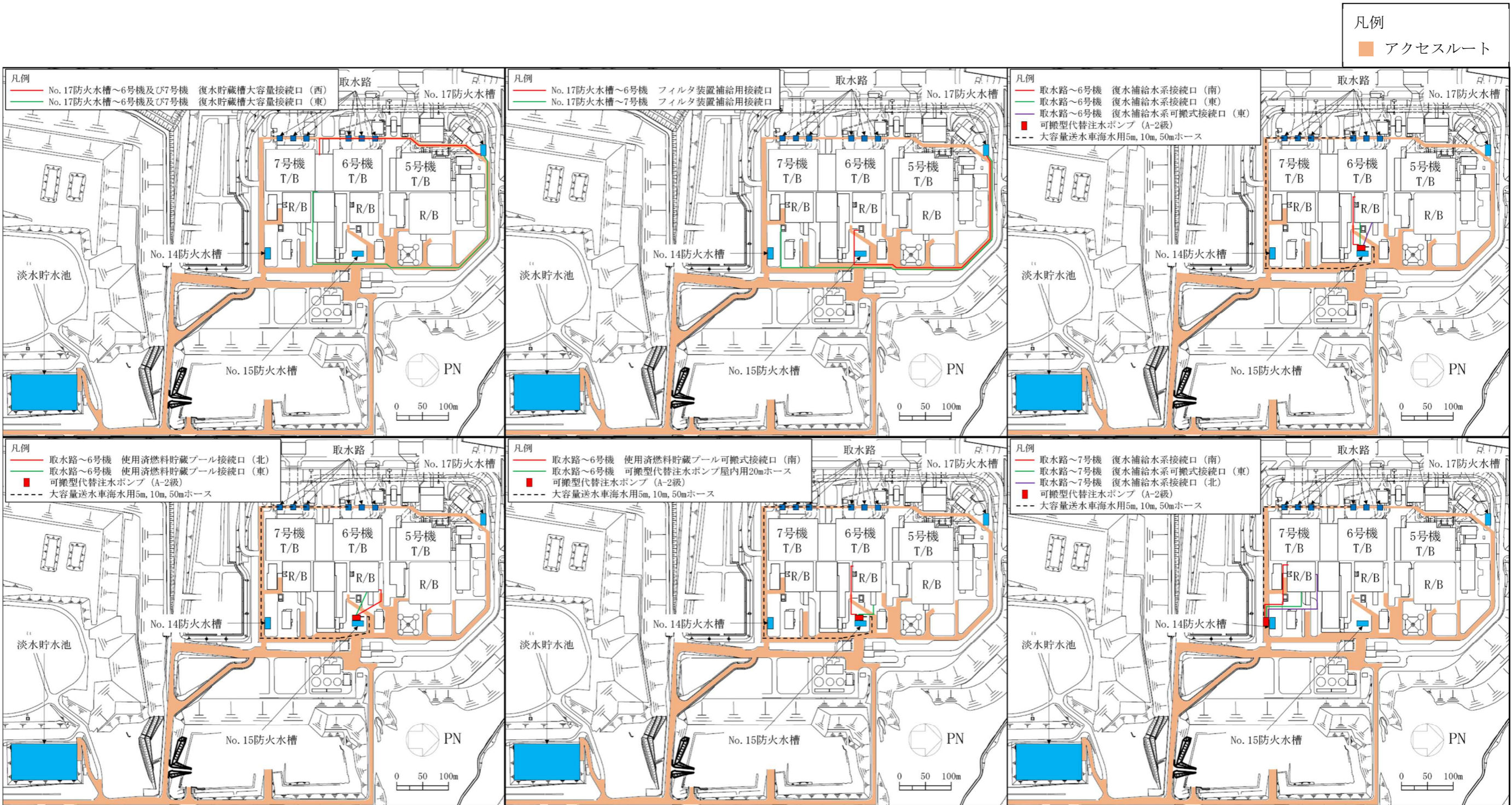
図 1-6 可搬型代替注水ポンプ屋外用 20m ホース 敷設ルート (6)
