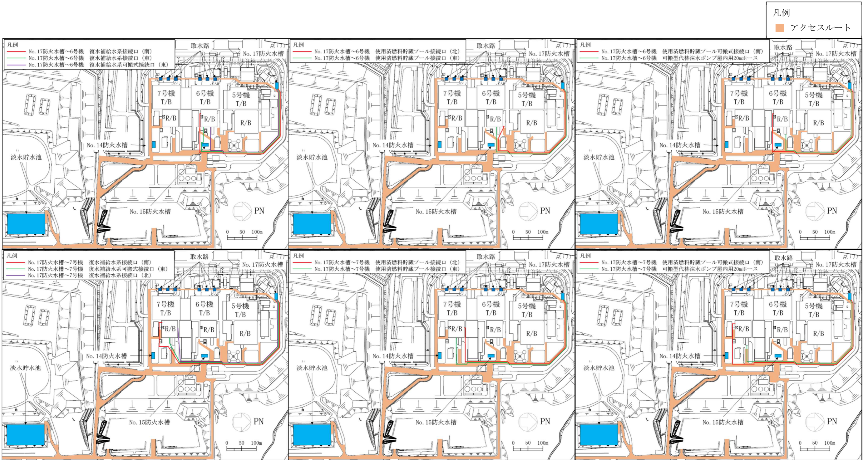
図 1-5 可搬型代替注水ポンプ屋外用 20m ホース 敷設ルート (5)
