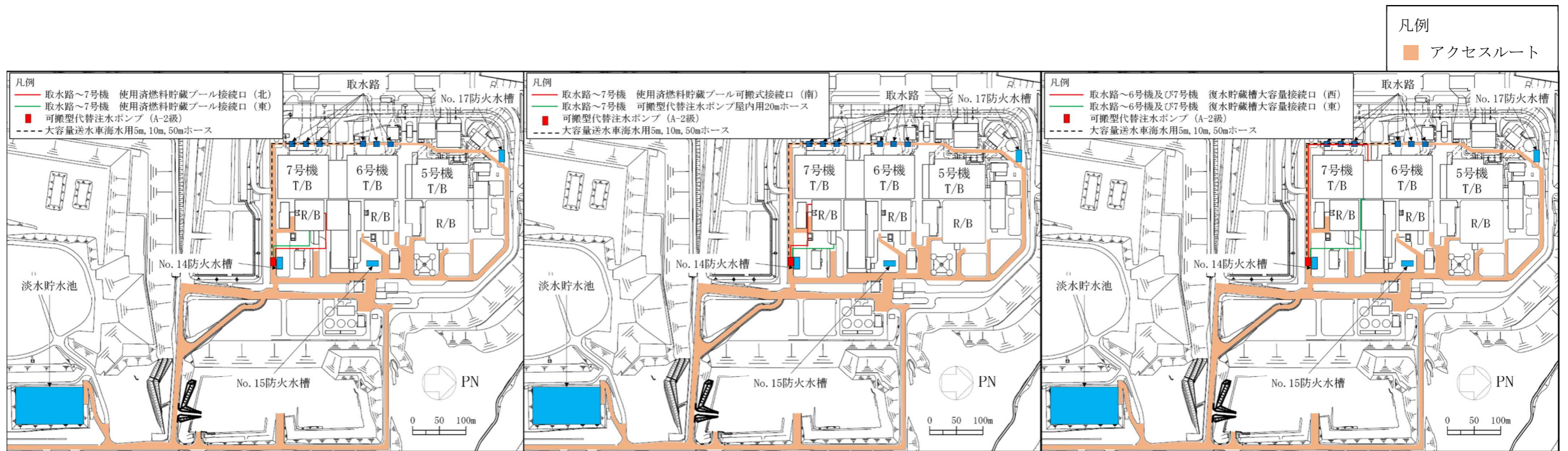
図 1-7 可搬型代替注水ポンプ屋外用 20m ホース 敷設ルート(7)
